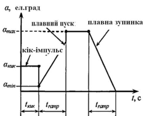
Рисунок 3.9 – Типова форма зміни кривої кута керування ТПН.
