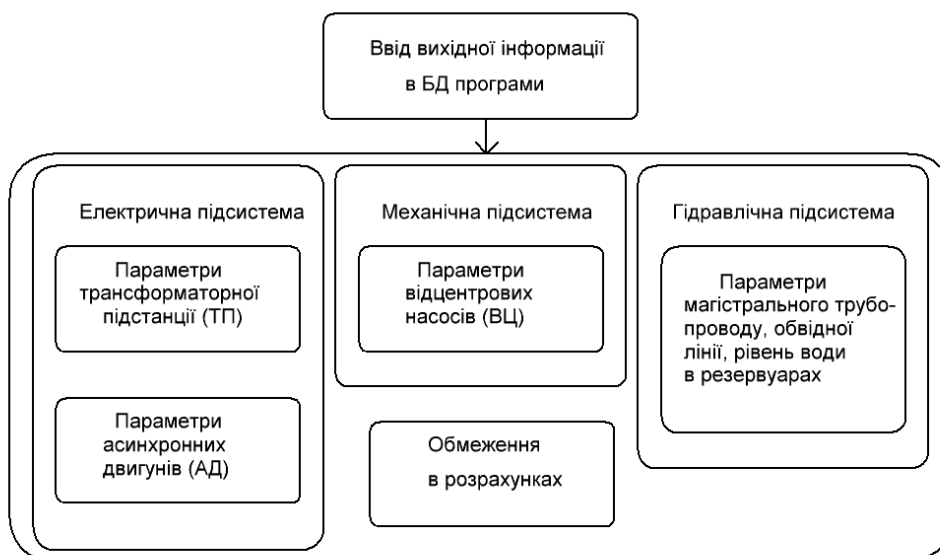
Рисунок 3.14 - Структура вихідних даних адаптивного алгоритму керування плавним пуском АД насосної станції
