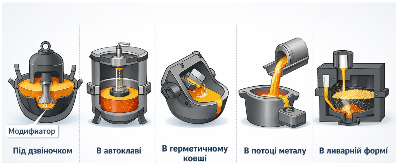
Рисунок 2.1 – Основні способи введення сфероїдизуючих модифікаторів у розплав чавуну
