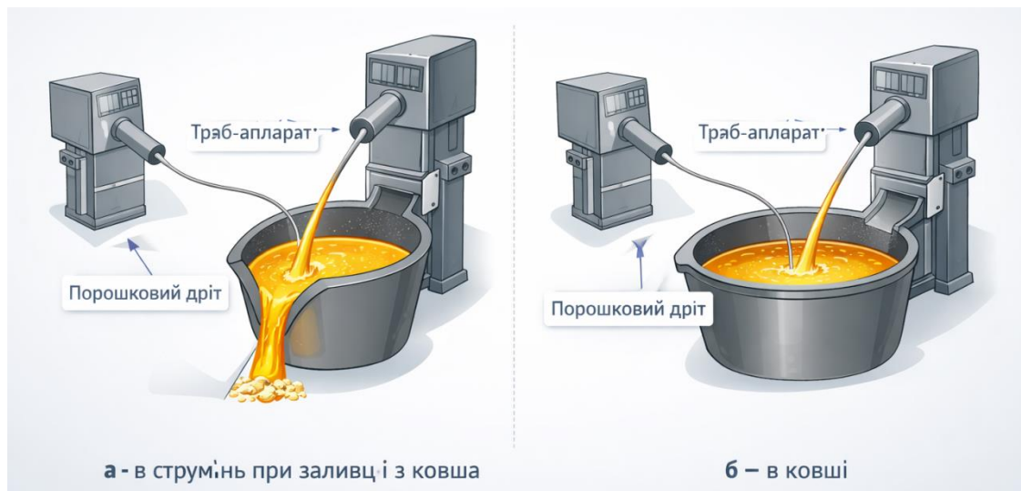
Рисунок 2.2 – Схеми обробки чавуну модифікуючим порошковим дротом
