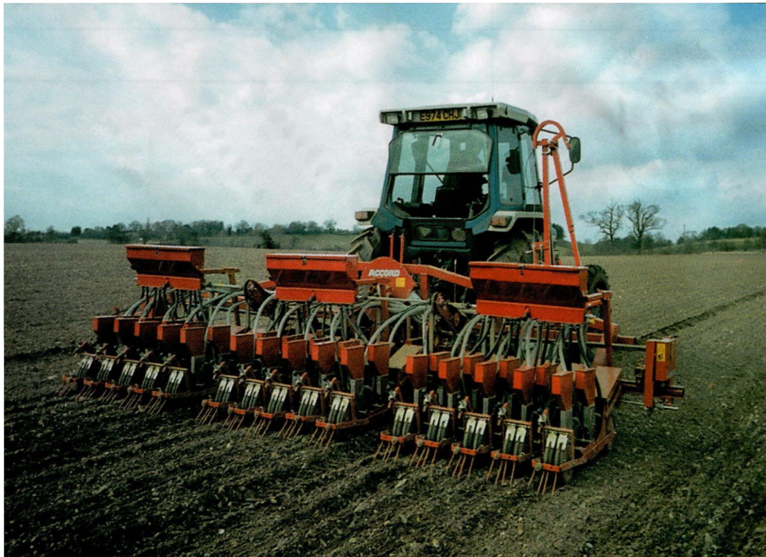
Рис. 5. Сівалка універсальної сівби овочевих культур «MiniairS»
