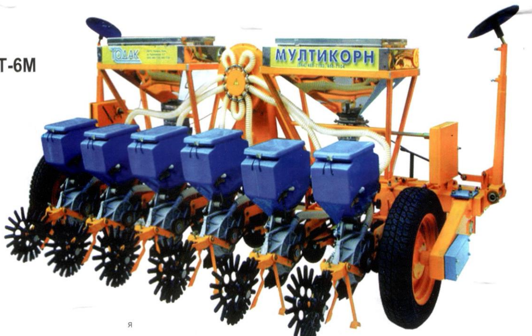
Рис. 6. Сівалка точної сівби просапних культур СТВТ – 6М
