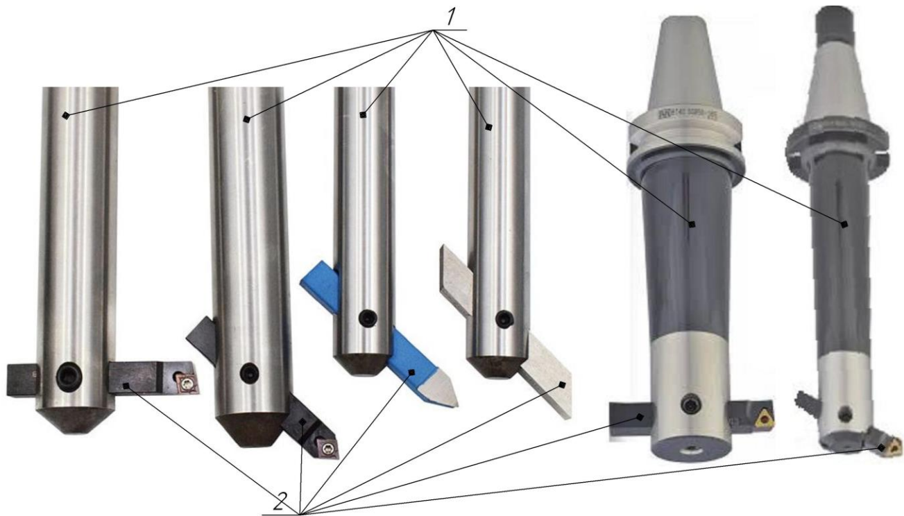
Рис. 2.6. Борштанги: 1 – оправка; 2 – різець
