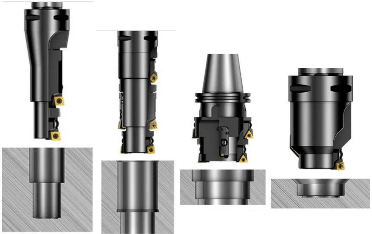
Рис. 2.39. Спеціальні розточувальні інструменти та оброблені ними отвори
