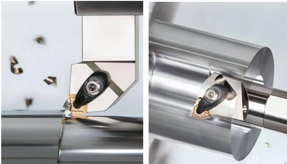
Рис. 2.1. Токарна обробка: а) – точіння; б) - розточування
