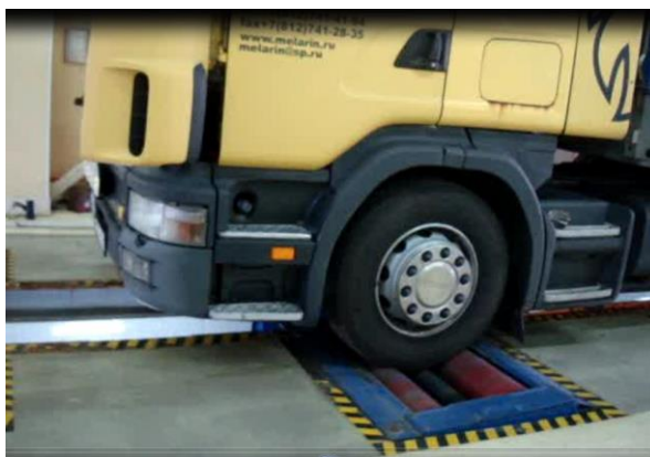
Рисунок 3.1- Встановлення передньої осі автомобіля на роликовий стенд
