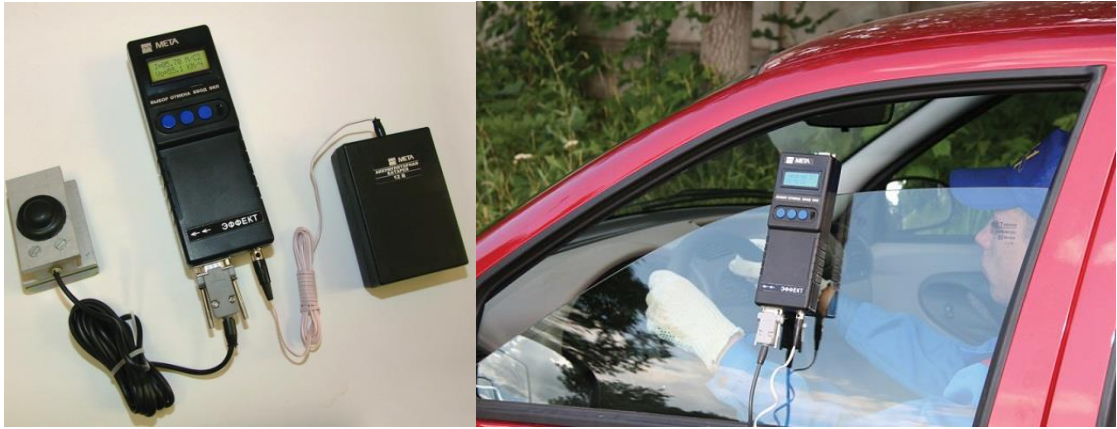
Рисунок 2.16 Тестер для контролю гальмівних систем
