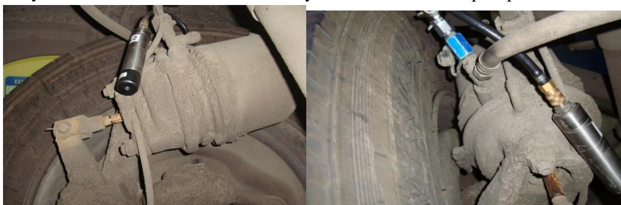
Рисунок 3.3- Пневматичний радіодатчик тиску
