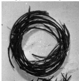
Рис. 1. Кільцеподібна стружка, що утворилась перед ріжучим зубцем із суцільним лезом
