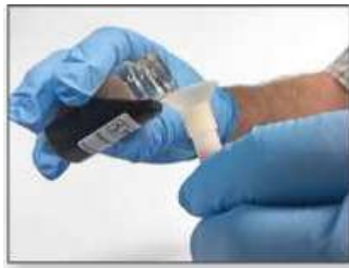
Рисунок 2.1. - Магнітометр FerroCheck 2100: а) загальний вигляд, б) процес відбору зразків, в) інформаційний дисплей приладу.
