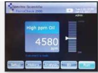
Рисунок 2.1. - Магнітометр FerroCheck 2100: а) загальний вигляд, б) процес відбору зразків, в) інформаційний дисплей приладу.
