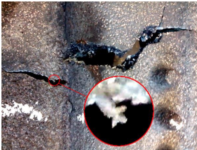
Рисунок 3.5 – Гаряча тріщина у вигляді наскрізного порушення суцільності вилівки та елемент дендритної структури з розвиненими гілками другого порядку
