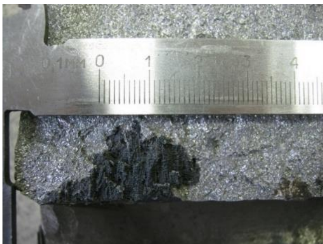
Рисунок 3.10 – Каскадний характер руйнування металу в зоні гарячої тріщини у сталевому виливку
