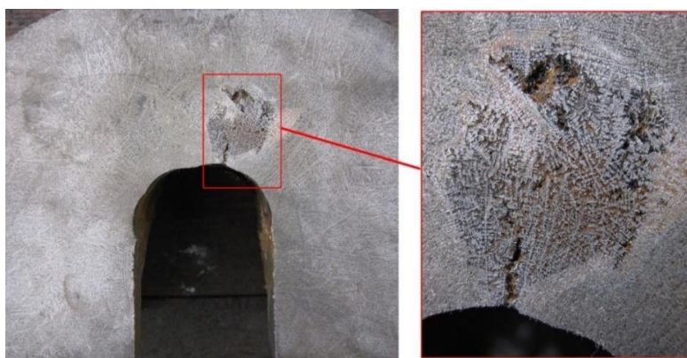
Рисунок 3.18 – Взаємозв'язок гарячої тріщини з усадочною пористістю у внутрішньому об'ємі сталевого вилівка
