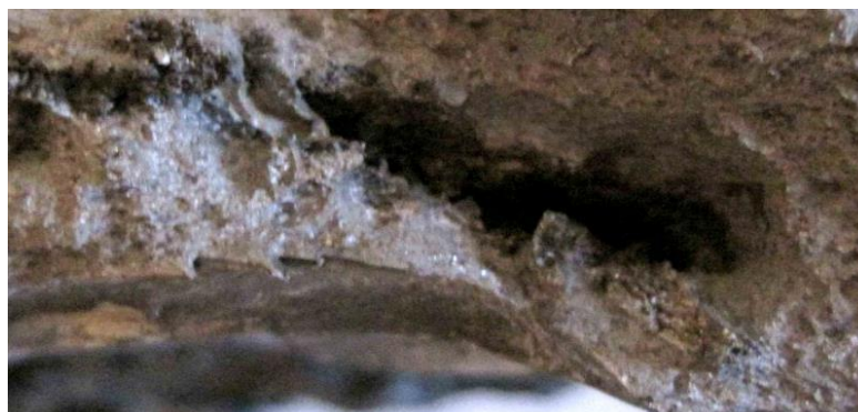
Рисунок 3.19 – Злам сталевого виливка з гарячою тріщиною, пов'язаною з усадочною раковиною, локалізованою в центральній частині стінки
