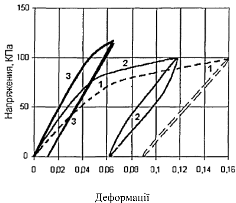
Рис. 2.9 Криві деформування глини тугопластичної (грунт № 4 в Таблиці 3.1) для трьох режимів зміни сдвигового зусилля S(t)
