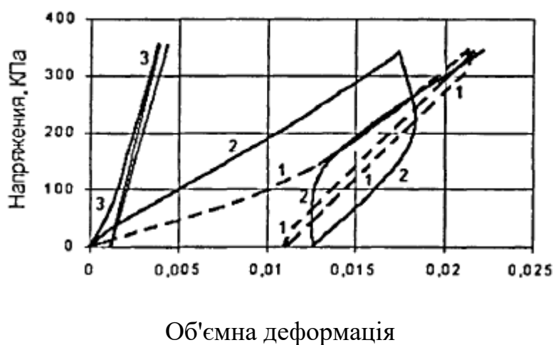
Рис. 2.15. Криві деформування глини тугопластичної (ґрунт № 4 в Таблиці 2.1) для трьох режимів зміни стискаючого зусилля |\sigma(t)| .
