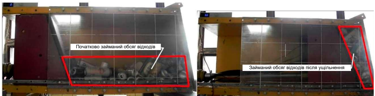
Рисунок 3.10 - Ущільнення металевих відходів при поступальному ущільненні
