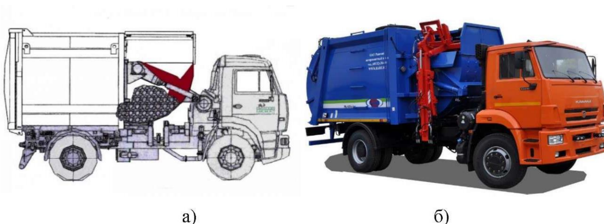
Рисунок 2.8 - Сміттєвози з пресуючою маятнковою плитою
