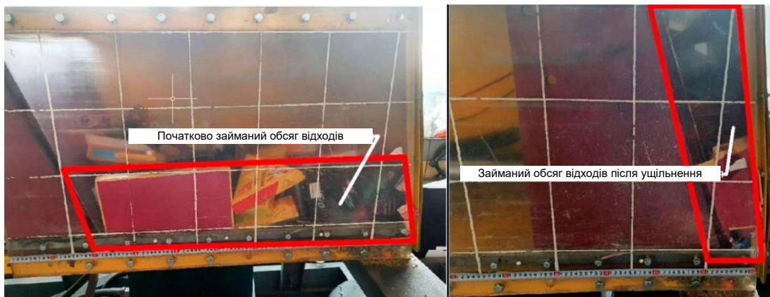
Рисунок 3.13 - Ущільнення паперових відходів при поступальному ущільненні
