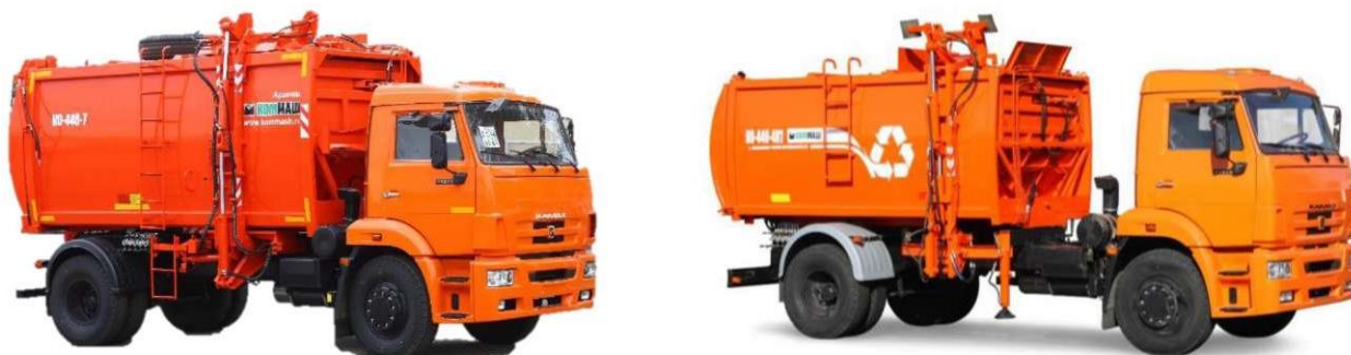
Рисунок 2.7 - Сміттєвози з бічним завантаженням
