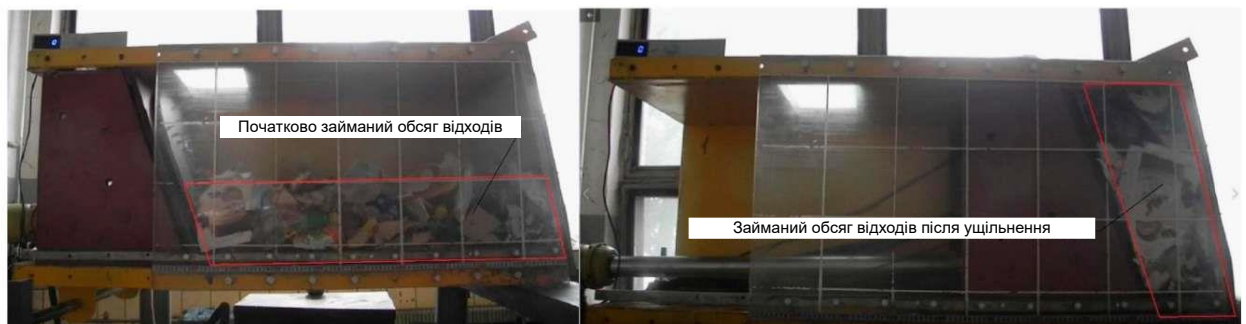
Рисунок 3.6 - Ущільнення відходів на стенді для фізичного моделювання ущільнення ТПВ
