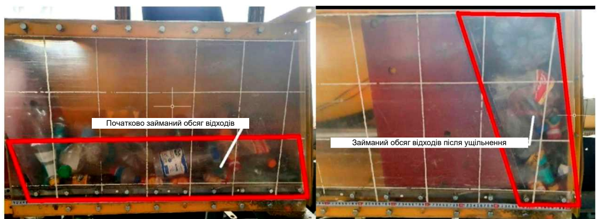
Рисунок 3.7 - Ущільнення пластикових відходів при поступальному ущільненні
