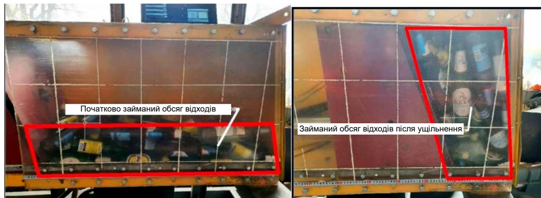
Рисунок 3.16 - Ущільнення скляних відходів при поступальному ущільненні
