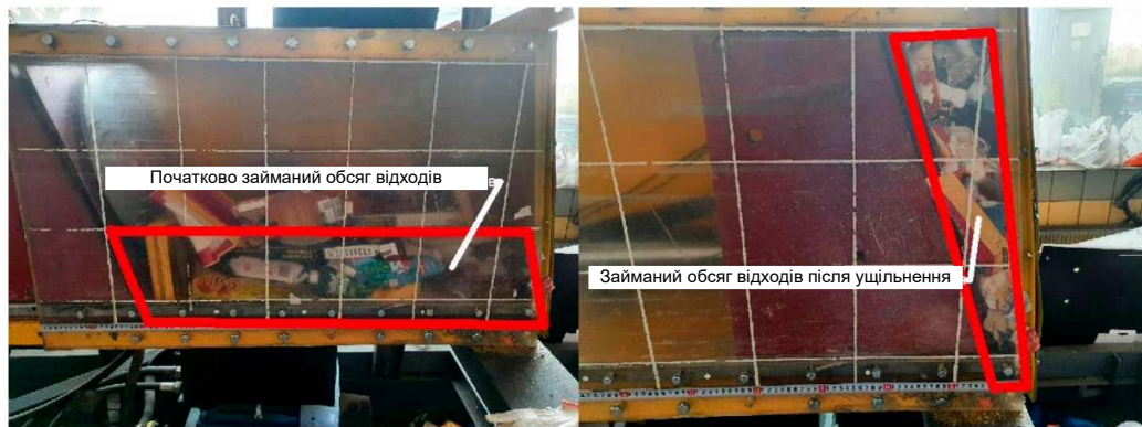
Рисунок 3.14 - Ущільнення паперових відходів при поступально-обертальному ущільненні
