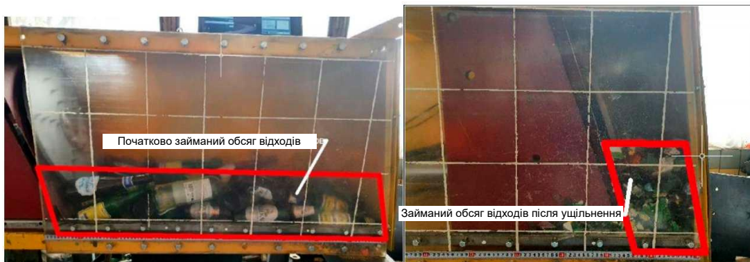
Рисунок 3.17 - Ущільнення скляних відходів при поступально-обертальному ущільненні
