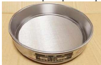
Рисунок 3 Сито GB/T6003.1-2012 з коміркою 74 мкм
