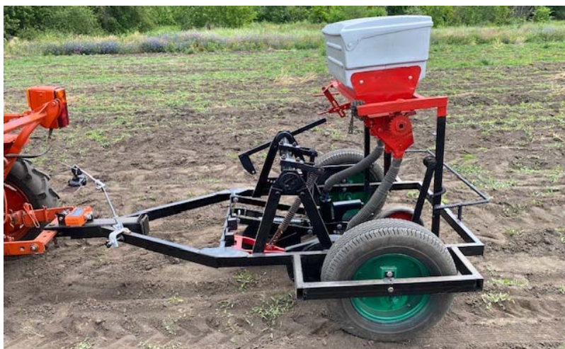
Рисунок 2 – Загальний вигляд посівного модуля для дослідження робочих органів посівних та ґрунтообробних машин
