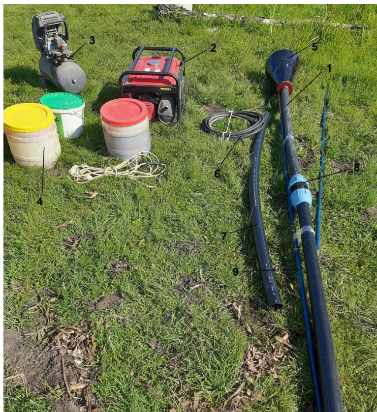
1 - ПМЗ для добування сапропелю; 2 – електричний генератор, 3 – поршневий компресор EURO 210/24; 4 – ємкості для відбору зразків добутого сапропелю; 5 – конічний корпус; 6 – трубопровід подачі стисненого повітря; 7 – відрізок підйимального трубопроводу; 8 – з’єднувальна муфта; 9 – каркас жорсткості
