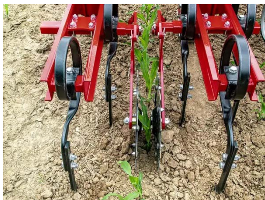
Рисунок 2 – Робочі органи культиватора Transformer VF фірми HORSCH з захисними дисками Джерело: [17]
