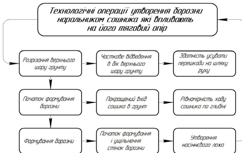
Рисунок 2 – Технологічні операції утворення борозни наральником сошника які впливають на його тяговий опір
