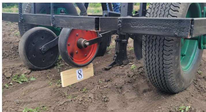
Рисунок 4 – Встановлення глибини ходу долотовидного сошника
