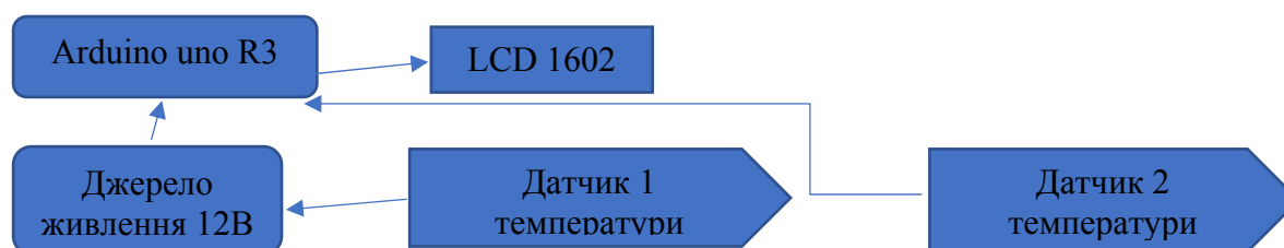
Рисунок 1 – Спрощена електрична схема вимірювального вузла Джерело: розроблено авторами
