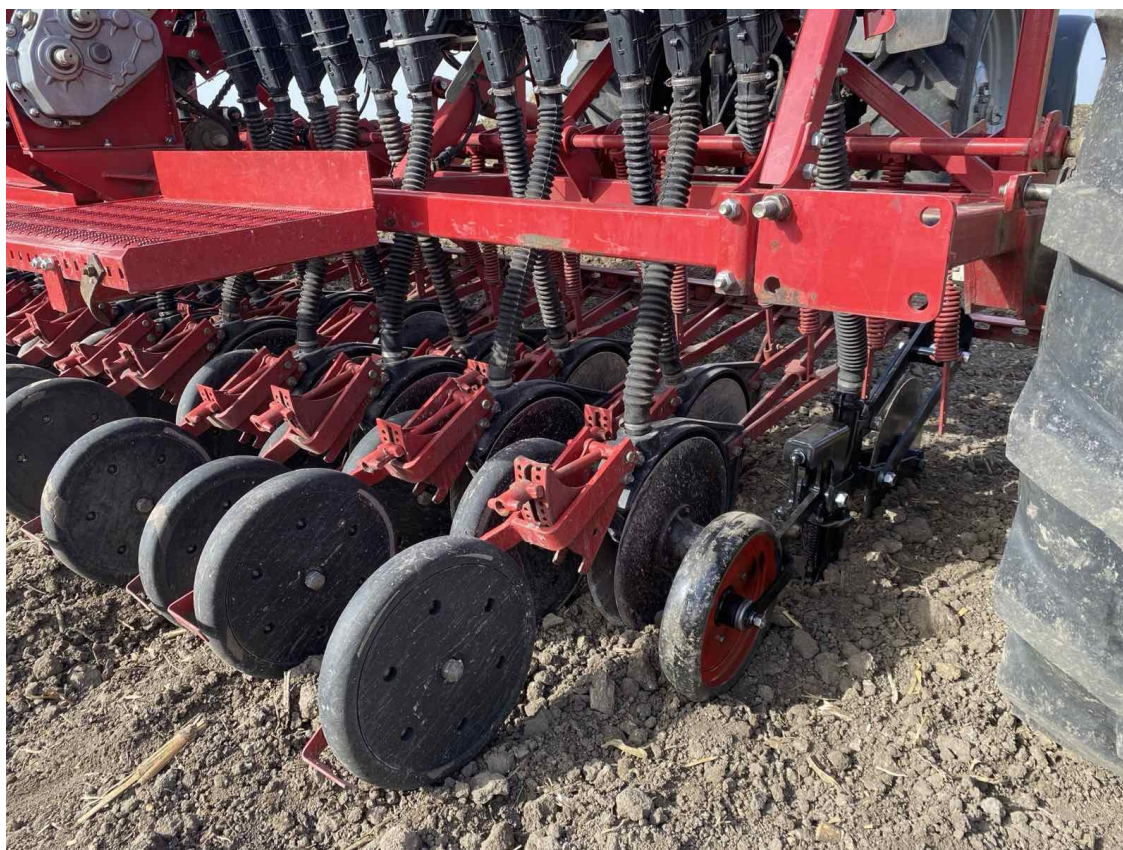
Рис. 3.1. Загальний вигляд сівалки з експериментальною посівною секцією на основі сошника з гострим кутом входження в ґрунт.
