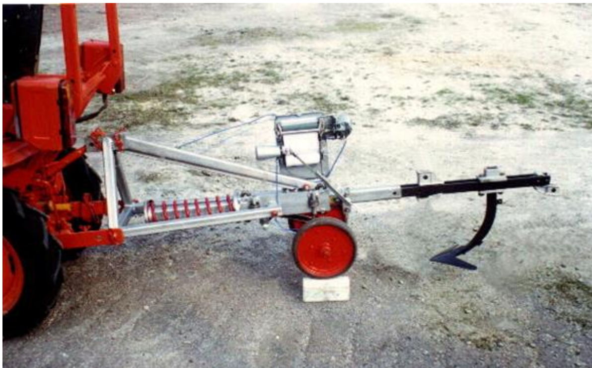
Рис. 3.1. Загальний вигляд дослідного комплексу в складі трактора Т-012 і спеціального замірювально-реєструючого пристрою
