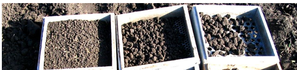
Рис. 3.2. Ситовий аналіз агрегатного складу обробленого ґрунту
