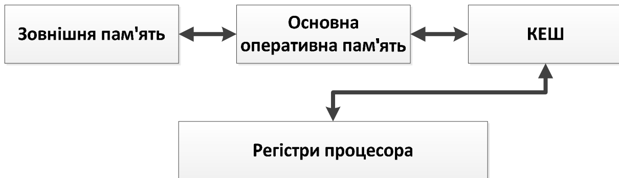
Рисунок 1.2 – Зв'язок ЗЗП з процесором
