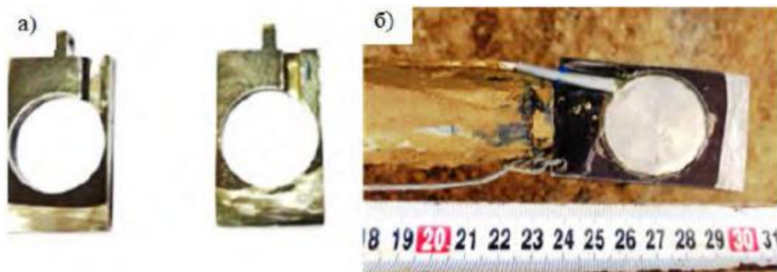
Рисунок 4.5 – Конструкція глибинних месдоз
