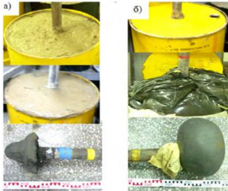
Рисунок 2.6 – Різні умови деформування ґрунту а – без привантаження, б – з привантаженням
