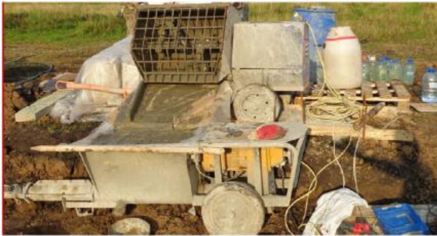
Рисунок 3.4 – Шнековий розчинонасос Putzmeister S5
