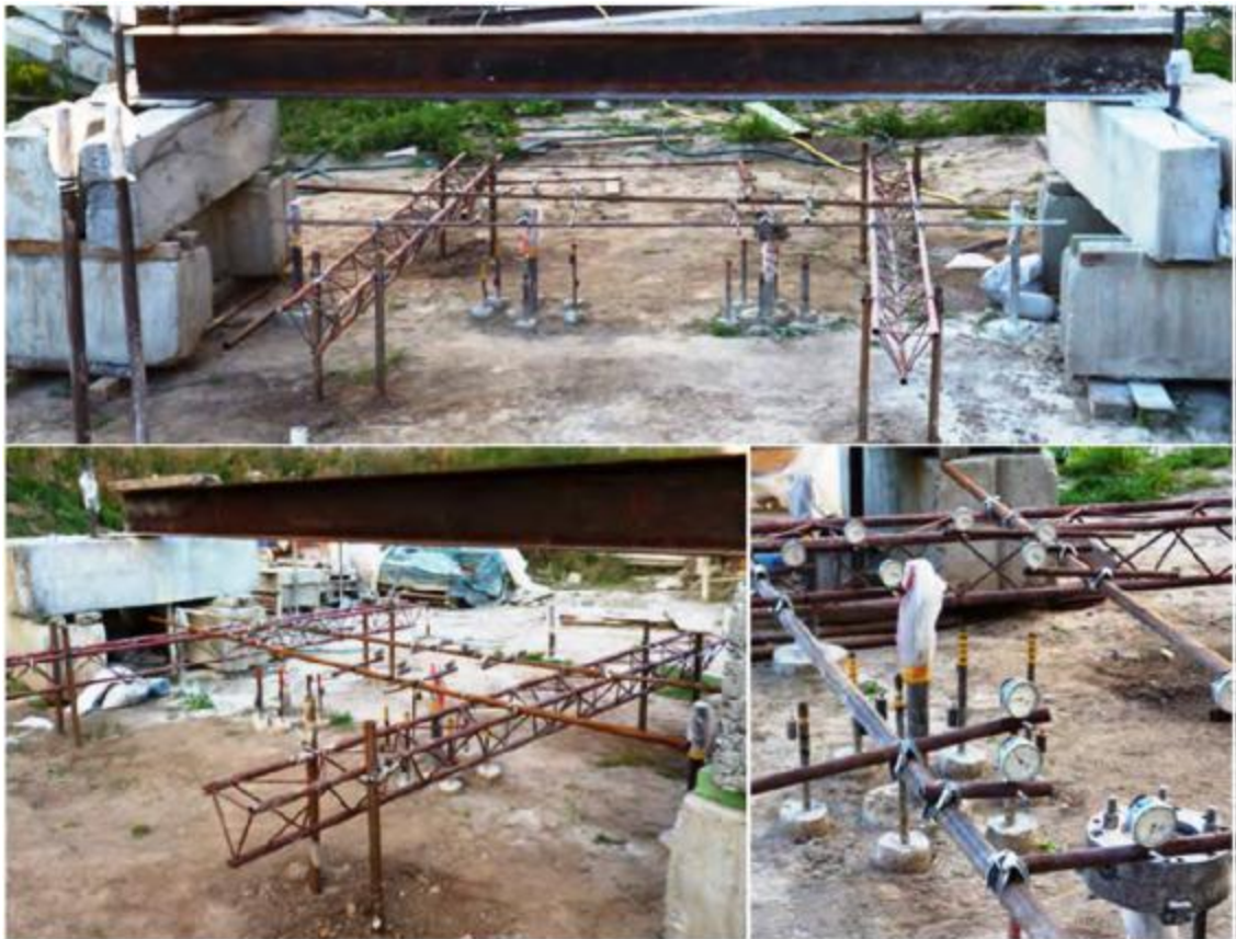
Рисунок 3.7 – Закріплення вимірювачів деформацій на реперній системі
