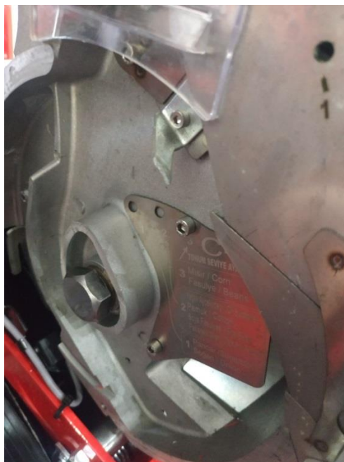
Рис. 3.4. Новий скидач пневмомеханічного висівного апарату
