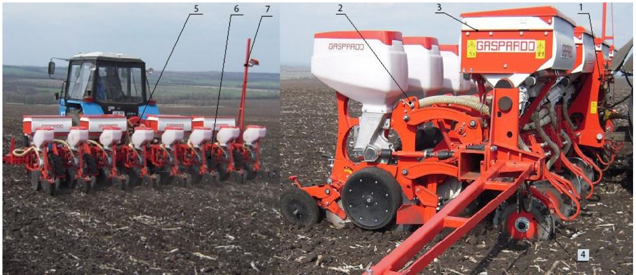
Рис. 2.3 Будова сівалки МТР-8 фірми Гаспардо
