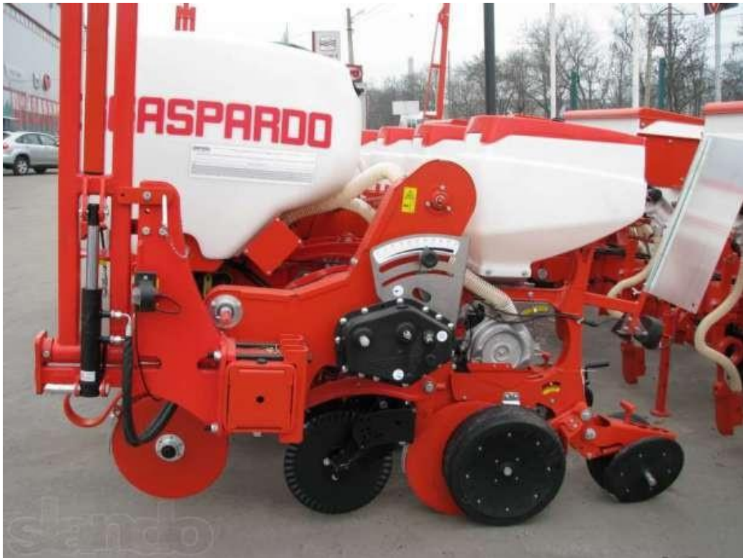
Рис. 2.2. Пневмомеханічна сівалка МТР-8 з дисковими сошниками
