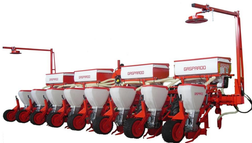
Рис. 2.1. Пневмомеханічна сівалка SP-8 з полозовидним сошником та основними комплектуючими фірми Gaspardo.[2]
