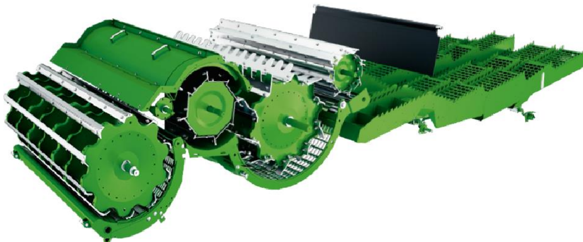
Рис. 3.6. Системи обмолоту та сепарації комбайнів JOHN DEERE серії Т
