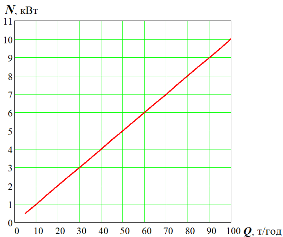
Рис. 3.27. Витрати потужності на привод двохстрічкового зернового шнека
