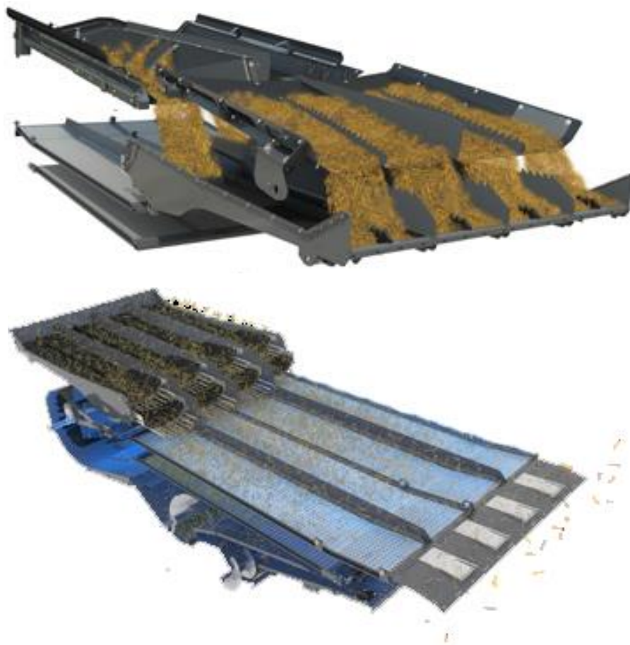
Рис. 3.17. Система очищення комбайна серії IDEAL
