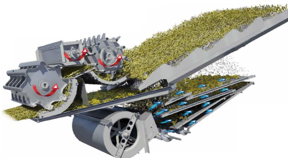
Рис. 3.22. Системи обмолоту, сепарації та очищення комбайнів NEW HOLLAND серії TC
