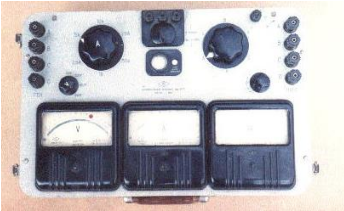
Рис. 3.8. Загальний вигляд контрольно-вимірювального приладу К-50
