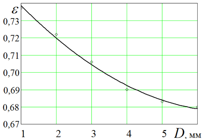
Рис. 4.1. Вплив діаметра калібруючих перетинок на просівну здатність колосового пруткового решета
