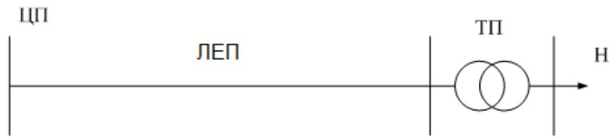
Рис. 5.1. Схема живильної електричної мережі 10 кВ
