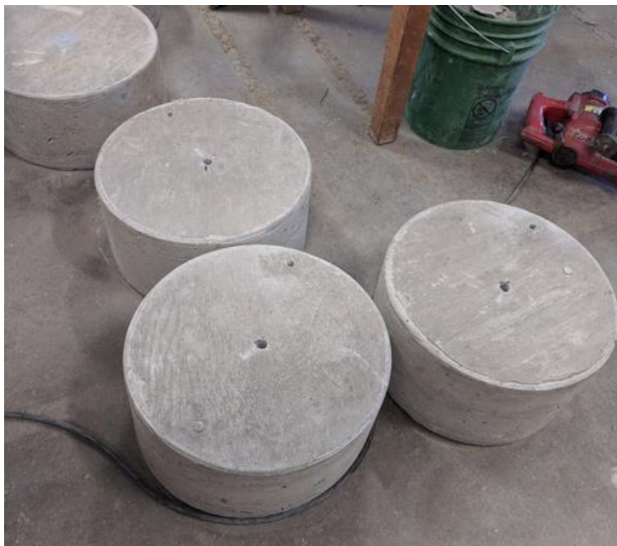
Рис. 2.2 Зразки бетону з просвердленими отворами під анкери
