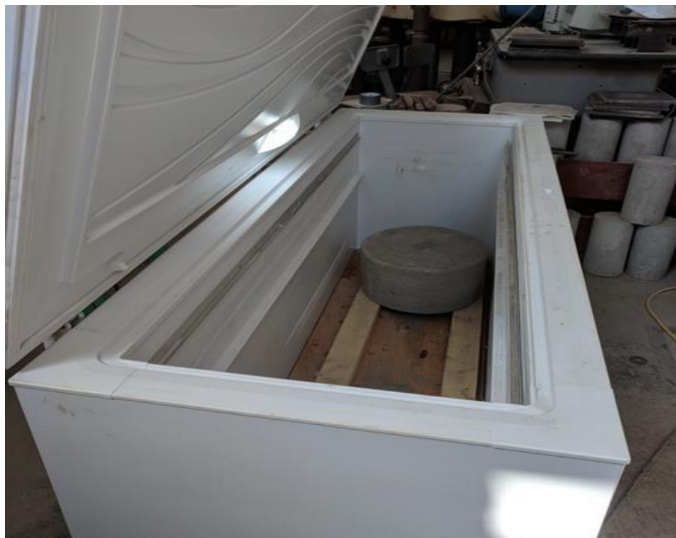
Рис. 2.7 Холодильна камера з одним лабораторним зразком всередині
