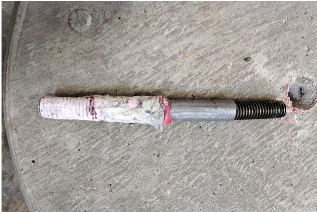
Рис. 3.1 Порушення клею в анкері
