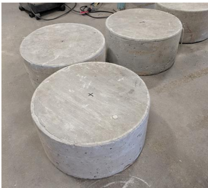
Рис. 2.1 Бетонні зразки з позначеним центром
