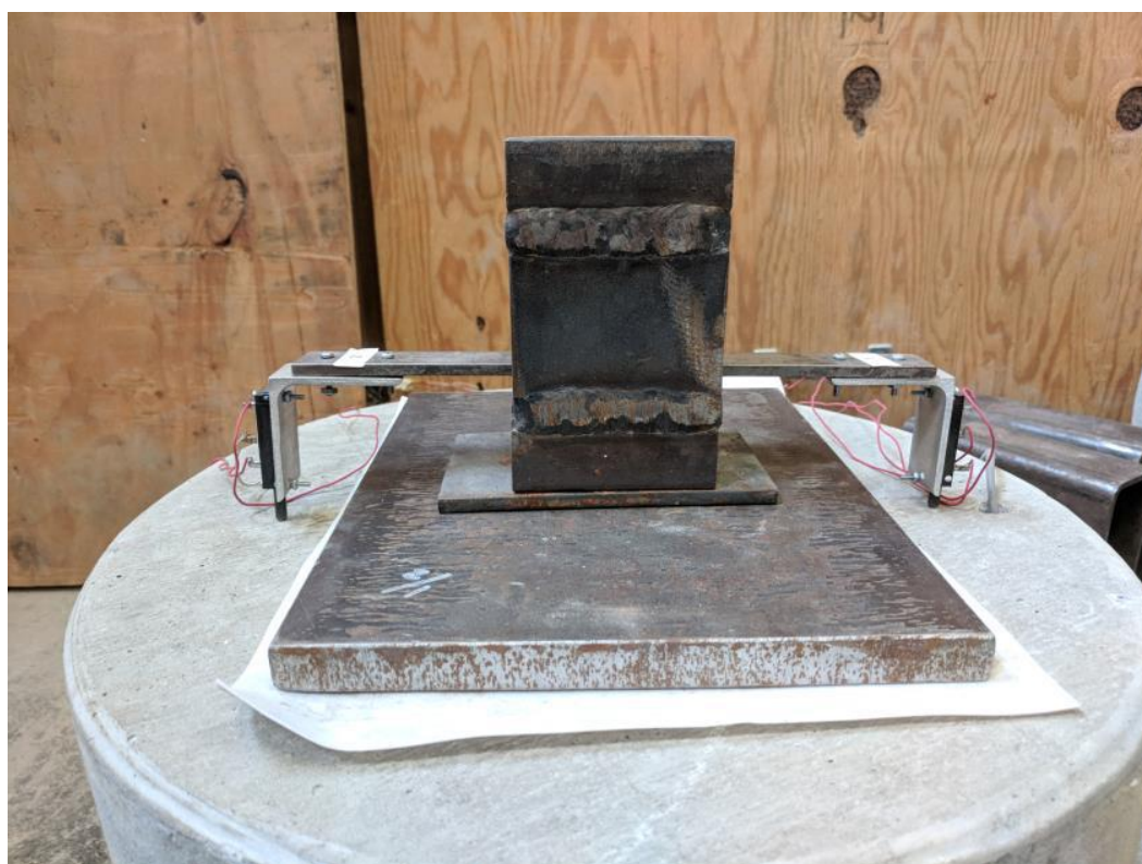
Рис. 2.10 Пристрій для зчитування з двома датчиками, прикріпленими до сталевій плоскій планки
