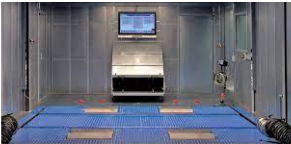
Рис.2.10 – Стенд для контролю потужності мод. МАНА MSR 1000
