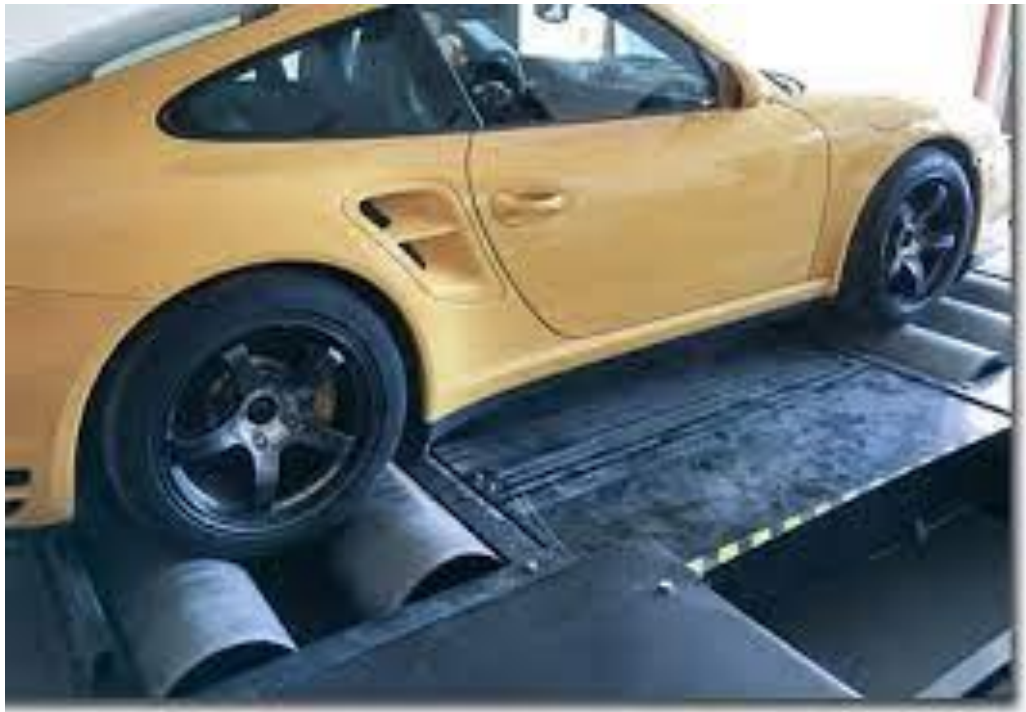
Рис.2.8 – Стенд динамометричний мод. DYNOMAX 4000 AWD BR
