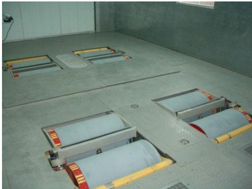
Рис.2.7 – Стенд динамічний, барабанний мод. СДМ 2-3500.200
