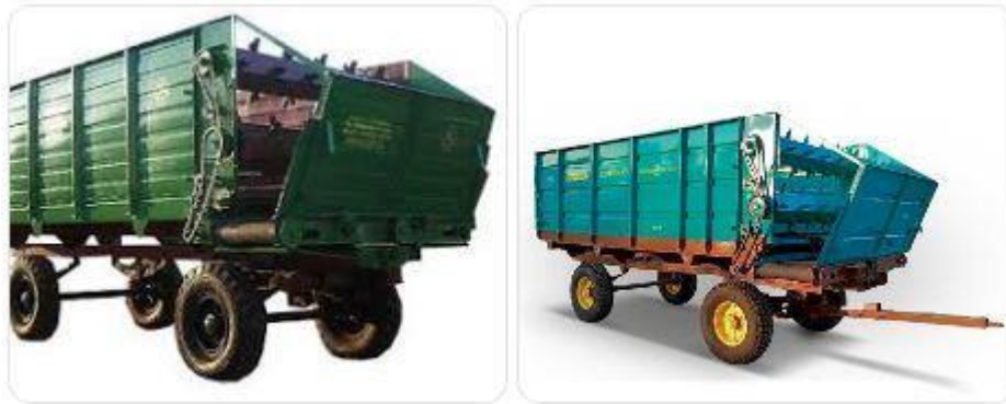
Рис. 2.2 – Кормороздавач КТУ з бункером-дозатором грубих кормів.
