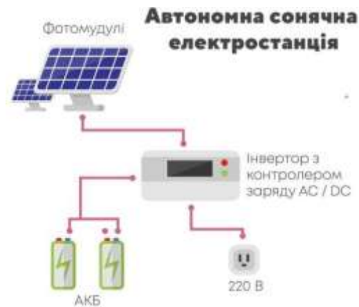
Рисунок 1.2. Варіант під'єднання мережевої фотоелектричної системи
