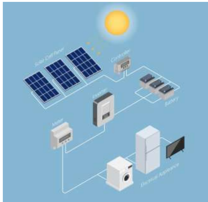
Рисунок 1.1 — Типова схема компонентів гібридної фотоелектричної системи з автономним режимом роботи (на прикладі ФЕС з акумуляторним накопичувачем для промислового об'єкта)
