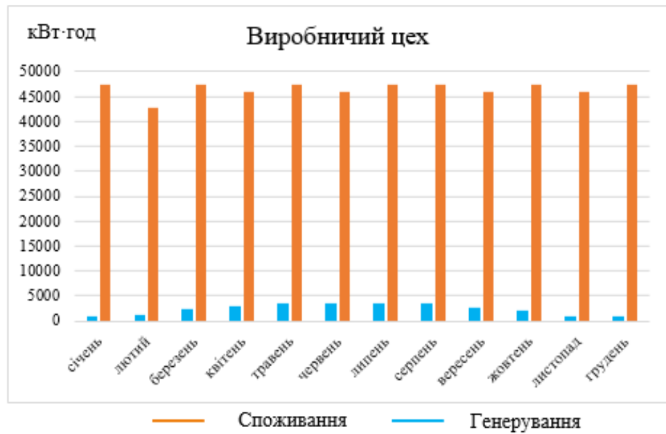
Рисунок 3.36 – Порівняння графіків споживання для генерування для основного виробничого цеху
