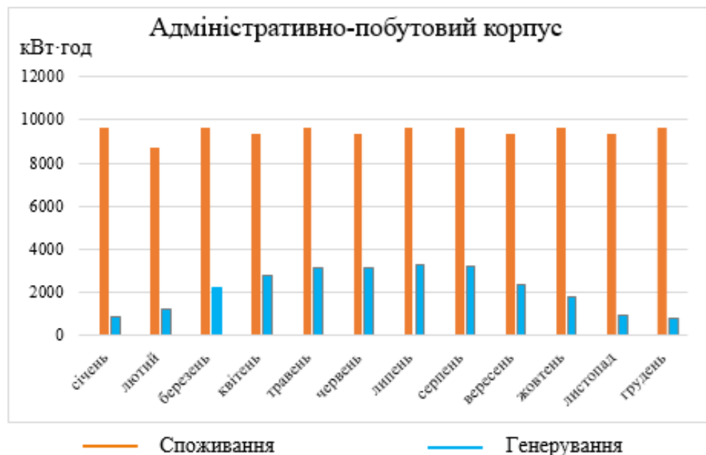
Рисунок 3.33 – Порівняння графіків споживання для генерування для АПК
