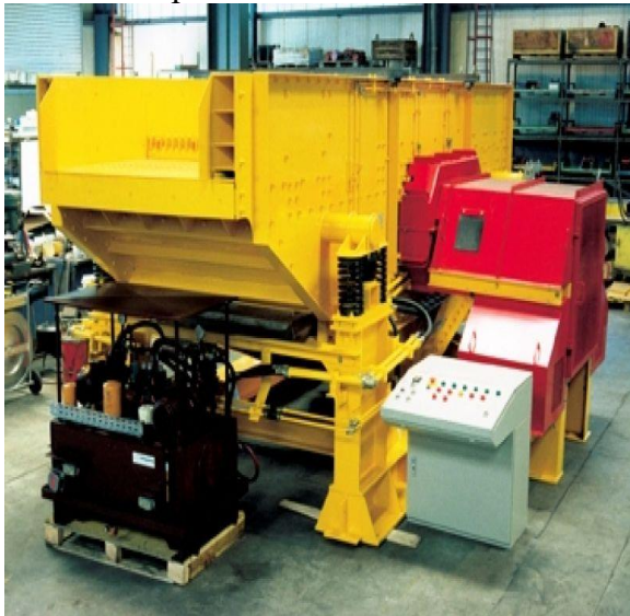
Рисунок 16.1 – Загальний вид та принципова схема вибивної ексцентрикової решітки
