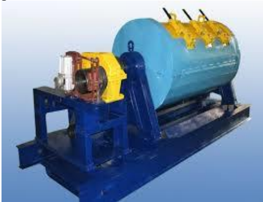
Рисунок 20.1 – Загальний вид та схема галтувального барабану періодичної дії
