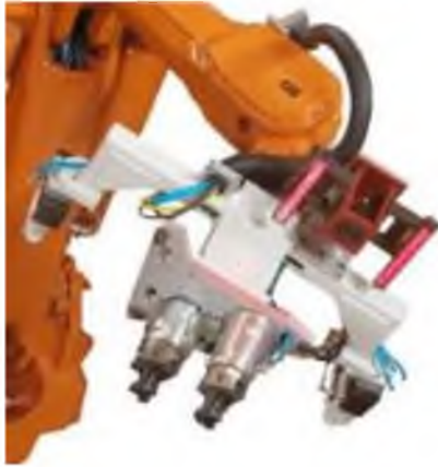
Рисунок 4.3 – Двозахватний пристрій фірми “ABB” /Швейцарія/
