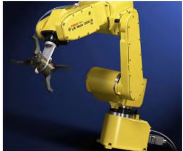
Рисунок 4.12 – Двозахватний робот LR Mate 200ІВ, фірми “Fanuk” /Японія/
