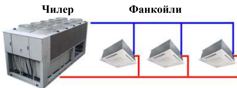
Рисунок 2.4 - Принципова схема функціонування системи "чилер – фанкойл"
