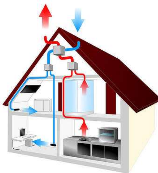
Рисунок 1.2 - Принципова схема примусово-витяжної вентиляції
