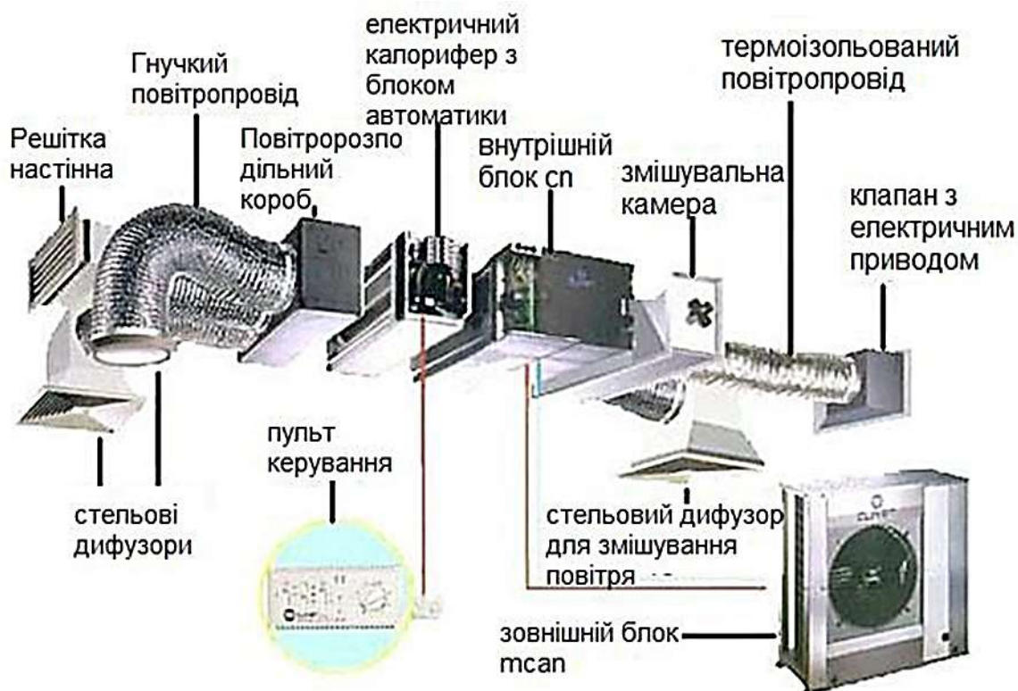
Рис.2.5 – Схема спліт-системи
