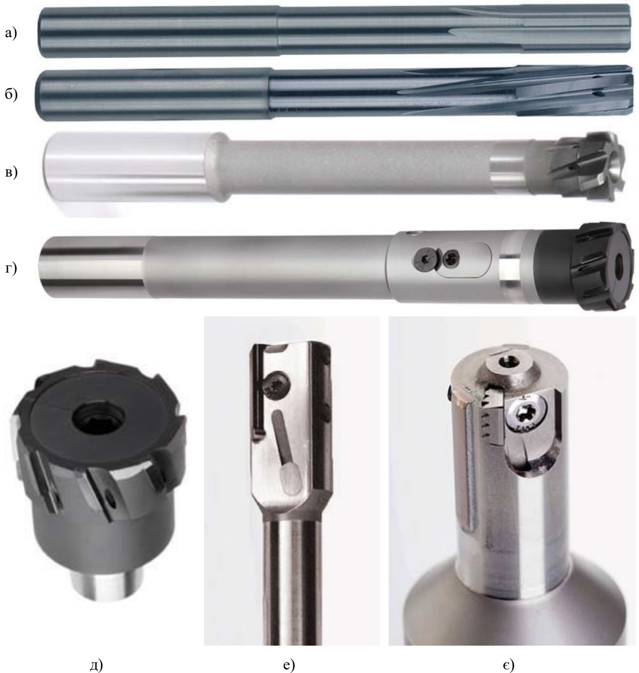
Рис. 2.10 Основні типи розверток для обробки отворів корпусних деталей.
