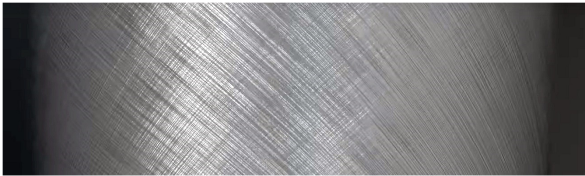
Рис. 2.19 Поверхня деталі після обробки методом хонінгування.
