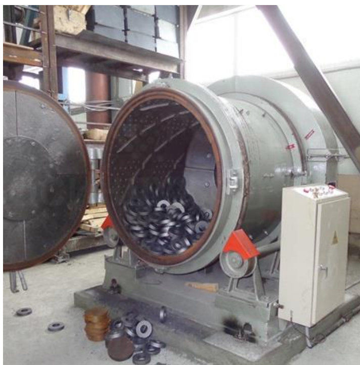
Рисунок 5 – Загальний вид дробометного барабану періодичної дії Гільйотини, ножиці, преса — для обрізки ливникової системи, розділення заготовок і підготовки до подальшої обробки.
