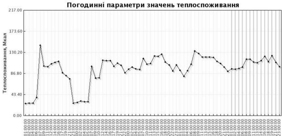
Рисунок 4.7. Погодинний графік споживання ТЕ для випадку низької температури навколишнього середовища та з автоматичним налаштуванням зниження температури у нічний період доби
