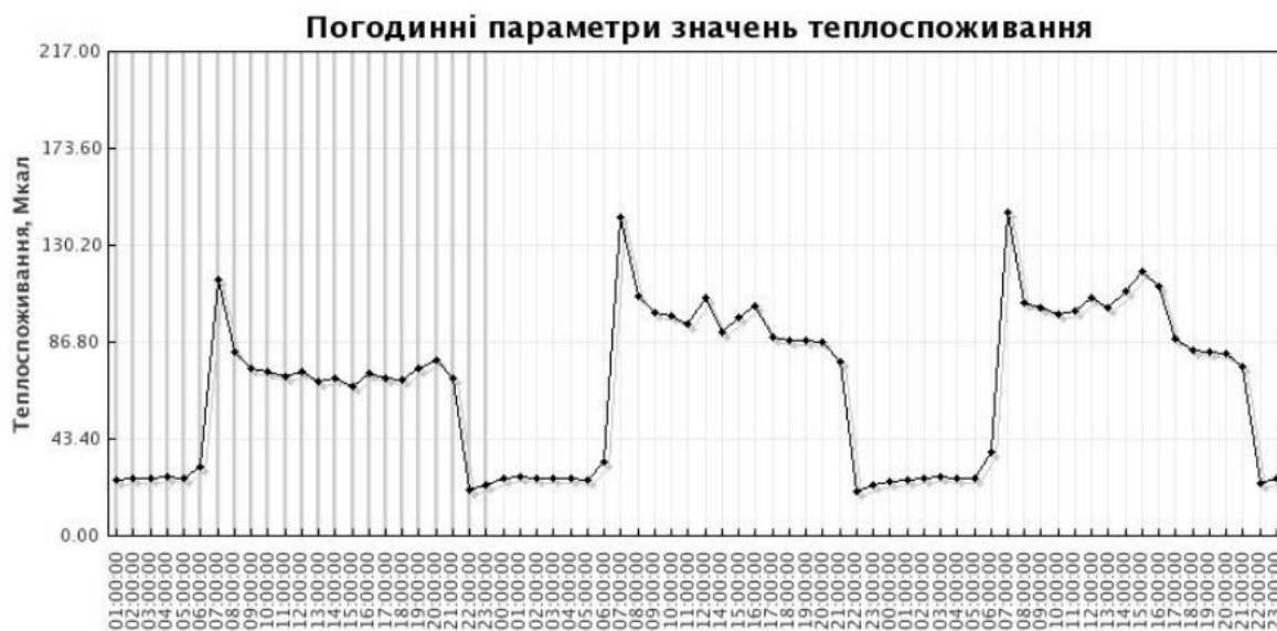
Рисунок 4.5. Графік споживання ТЕ з автоматичним налаштуванням зниження температури у нічний період доби
