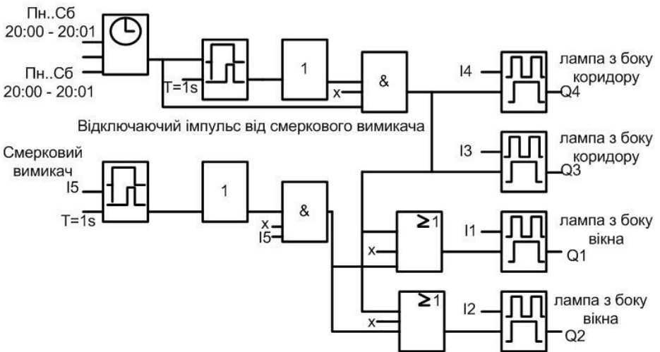
Рис 9.4. Функціональна блок-схема керування освітленням з використанням контролера LOGO!
