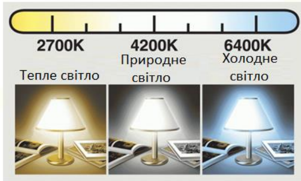
Рис. 4.17. Спектр випромінювання ламп в залежності від колірної температури
