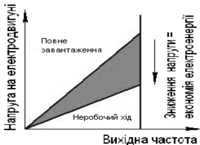
Рис. 4.18 Діаграма енергоощадного режиму електропривода
