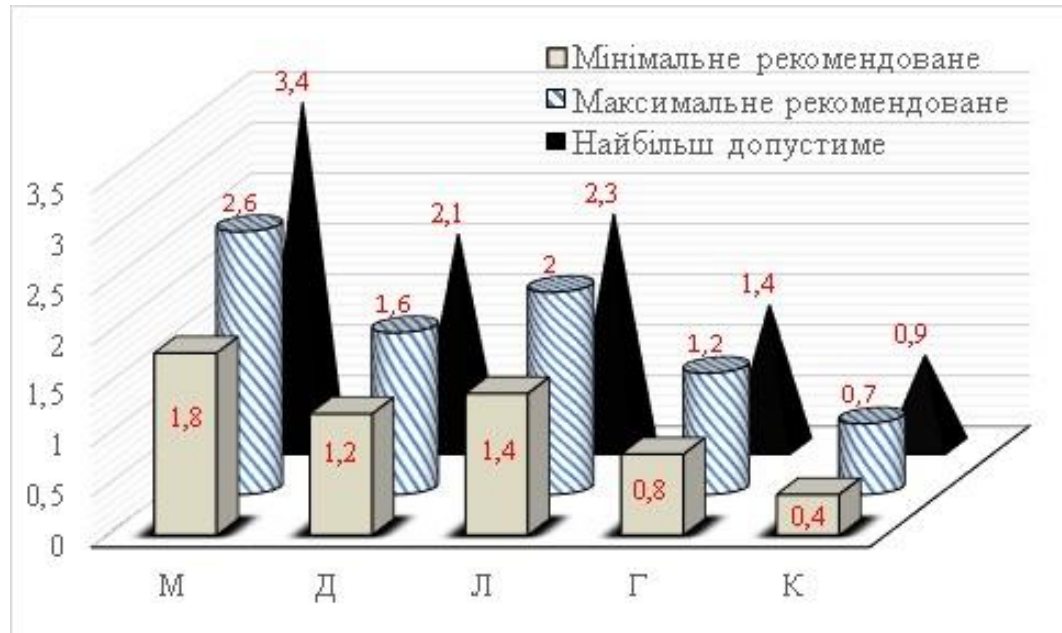
Рис 7.3. Графічні номограми залежності відносного кроку l від типології фотометричного розподілу
