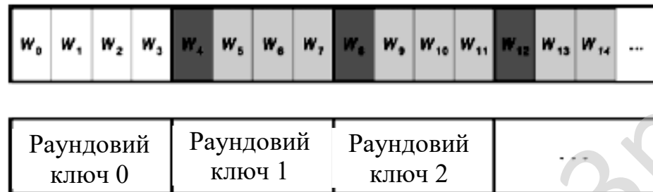
Рисунок 3.2 – Процедури розширення й виборки раундового ключа для Nk = 4
