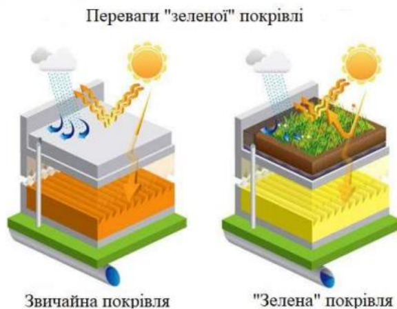
Рисунок 18 . Схематичне зображення переваг «зеленої» покрівлі
