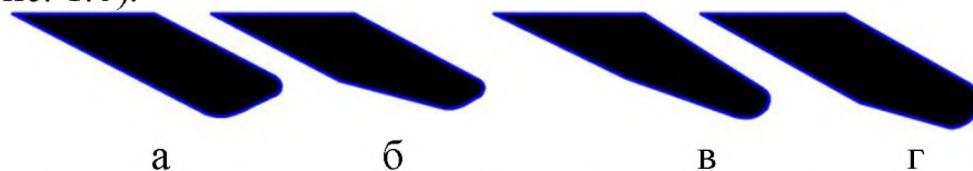
Рисунок 1.6 – Характер зміни профілю РЕ стрілчастих лап на різних ґрунтах: а і б – суглинисті; в і г – глинисті (напрацювання 40 і 80 га)
