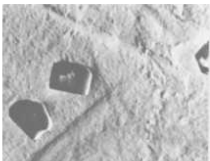
Рисунок 3.21 – Екстрагувані титановмісні включення в ( \times 100000 ).
