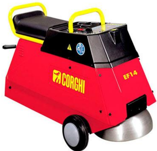
а-загальний вигляд; б - встановлення датчика при балансуванні Рисунок 3.8 - Прилад для балансування коліс на автомобілі
