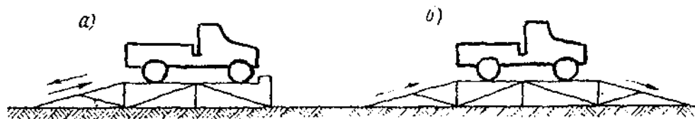
Рисунок 1.2- Схема будови естакад: а - тупикова; в - прямоточна.
