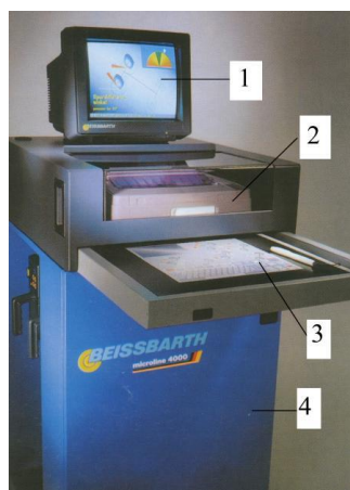
1 – монітор; 2 – клавіатура; 3 – графічний планшет; 4 – корпус
