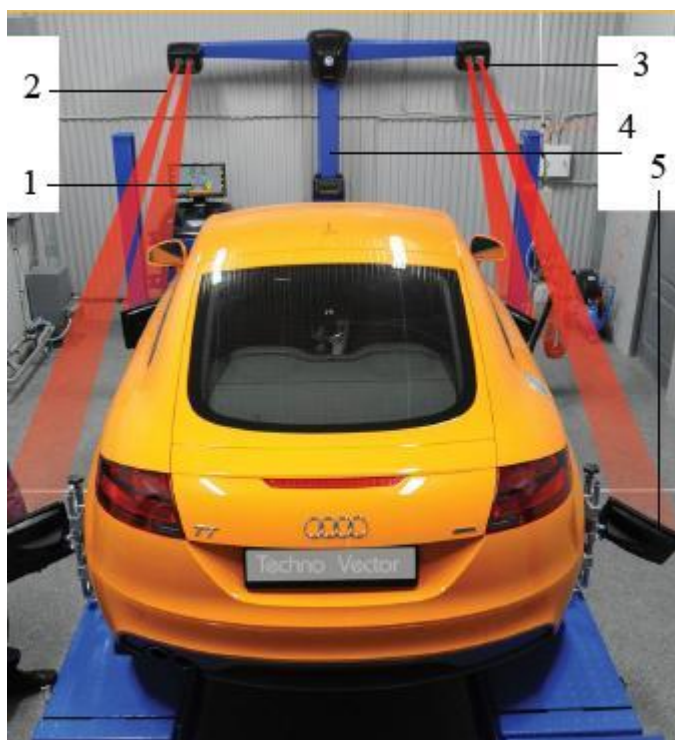
1 – комп'ютер; 2 – лазерний промінь; 3 – камера; 4 – стійка; 5 – мішень Рисунок 4.10 - Загальний вид станда з використанням 3D технологій.
