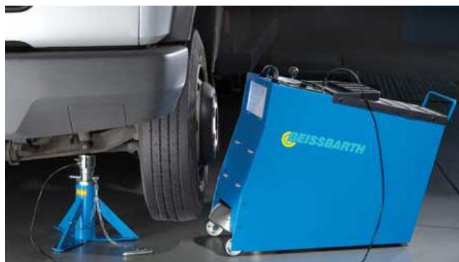
а-загальний вигляд; б - встановлення датчика при балансуванні Рисунок 3.8 - Прилад для балансування коліс на автомобілі
