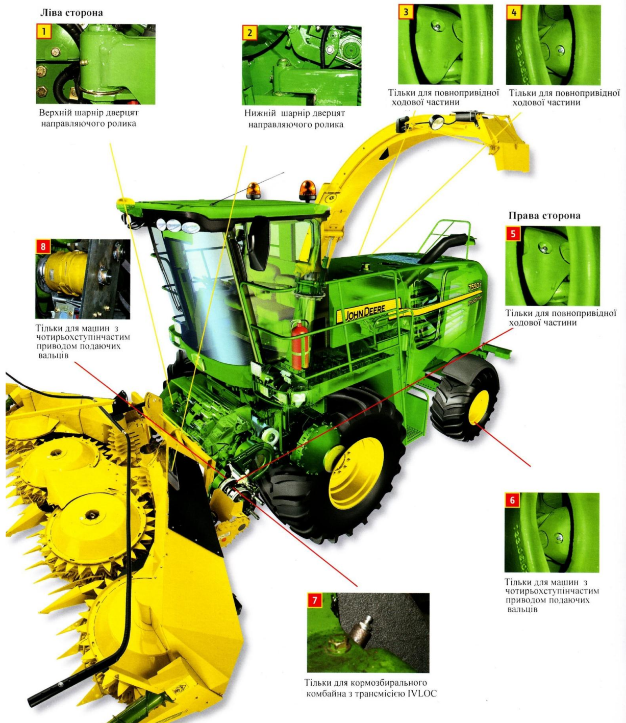
Рисунок 3.3 – Схема проведення мащення кормозбирального комбайна John Deere 7550i після напрацювання 250 мотогодин.
