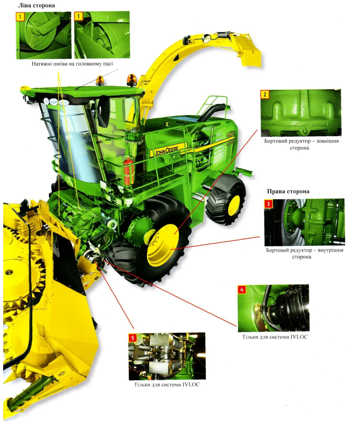
Рисунок 3.4 – Схема проведення мащення кормозбирального комбайна John Deere 7550i після напрацювання 500 мотогодин.
