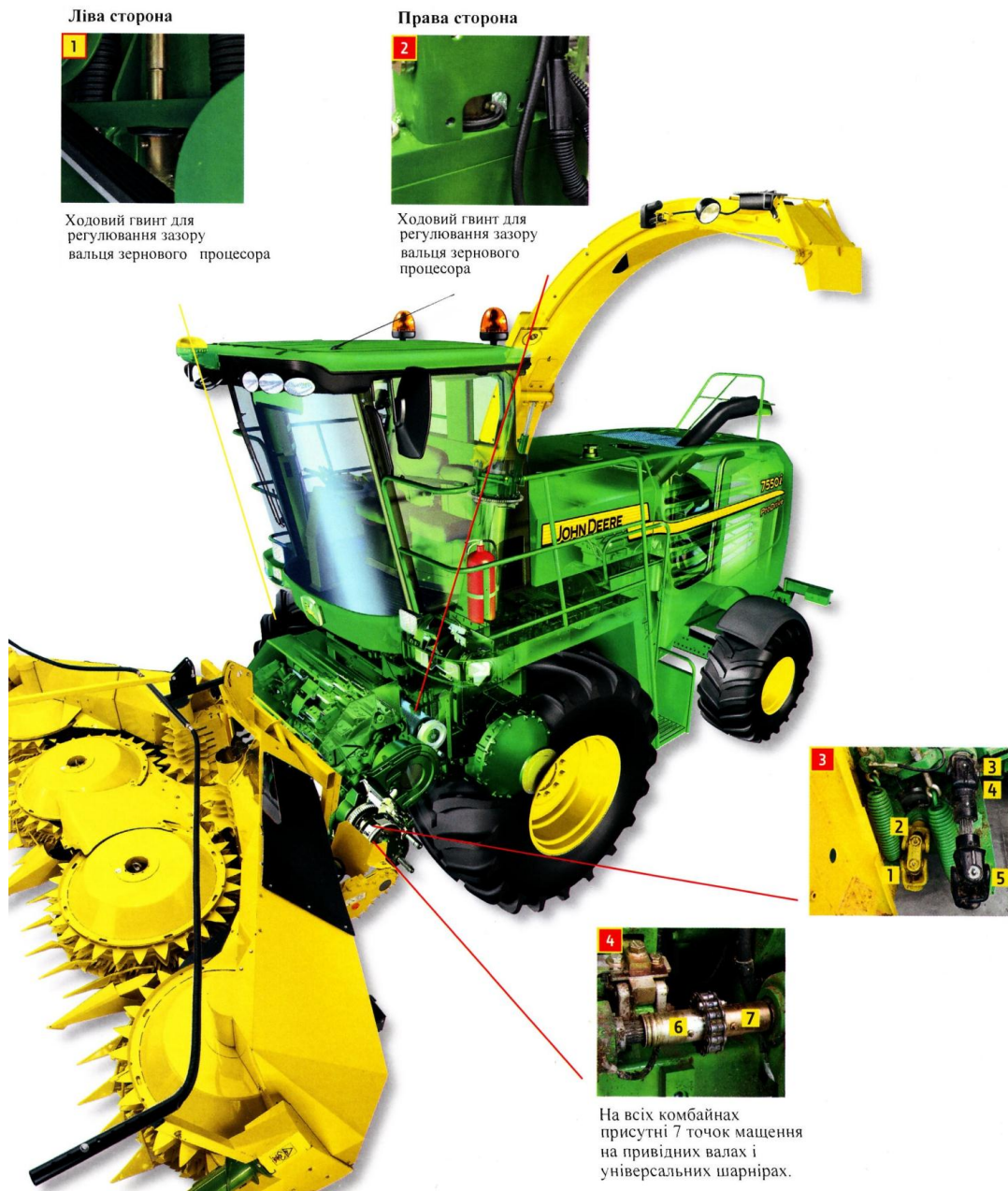
Рисунок 3.1 – Схема проведення щоденного мащення кормозбирального комбайна John Deere 7550i.
