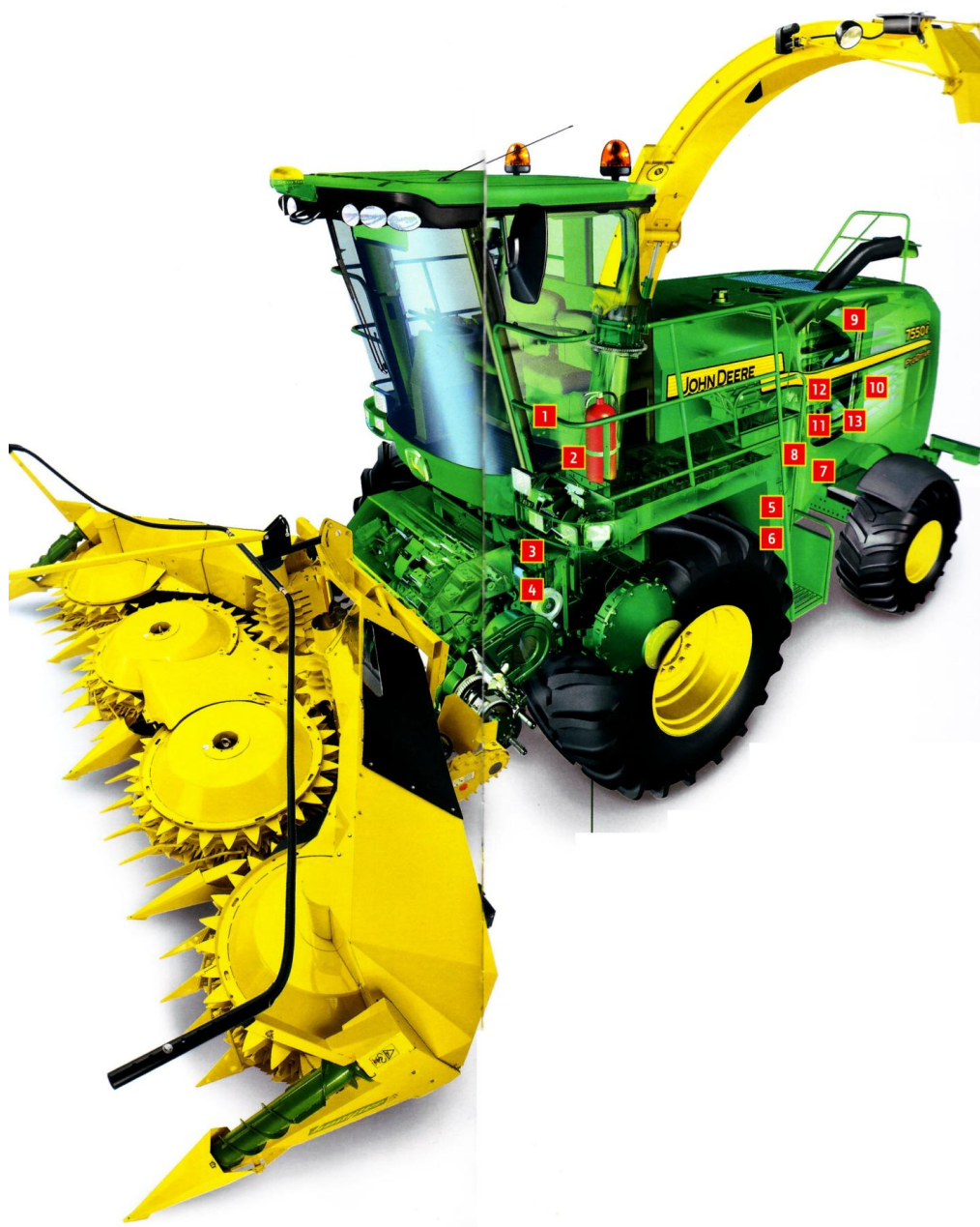
Рисунок 3.5 – Схема заміни фільтруючих елементів кормозбирального комбайна John Deere 7550i.
