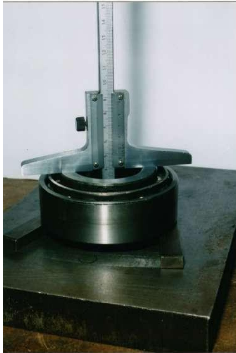
Рисунок 8 – Контроль монтажної висоти за допомогою штангенглибиноміру
