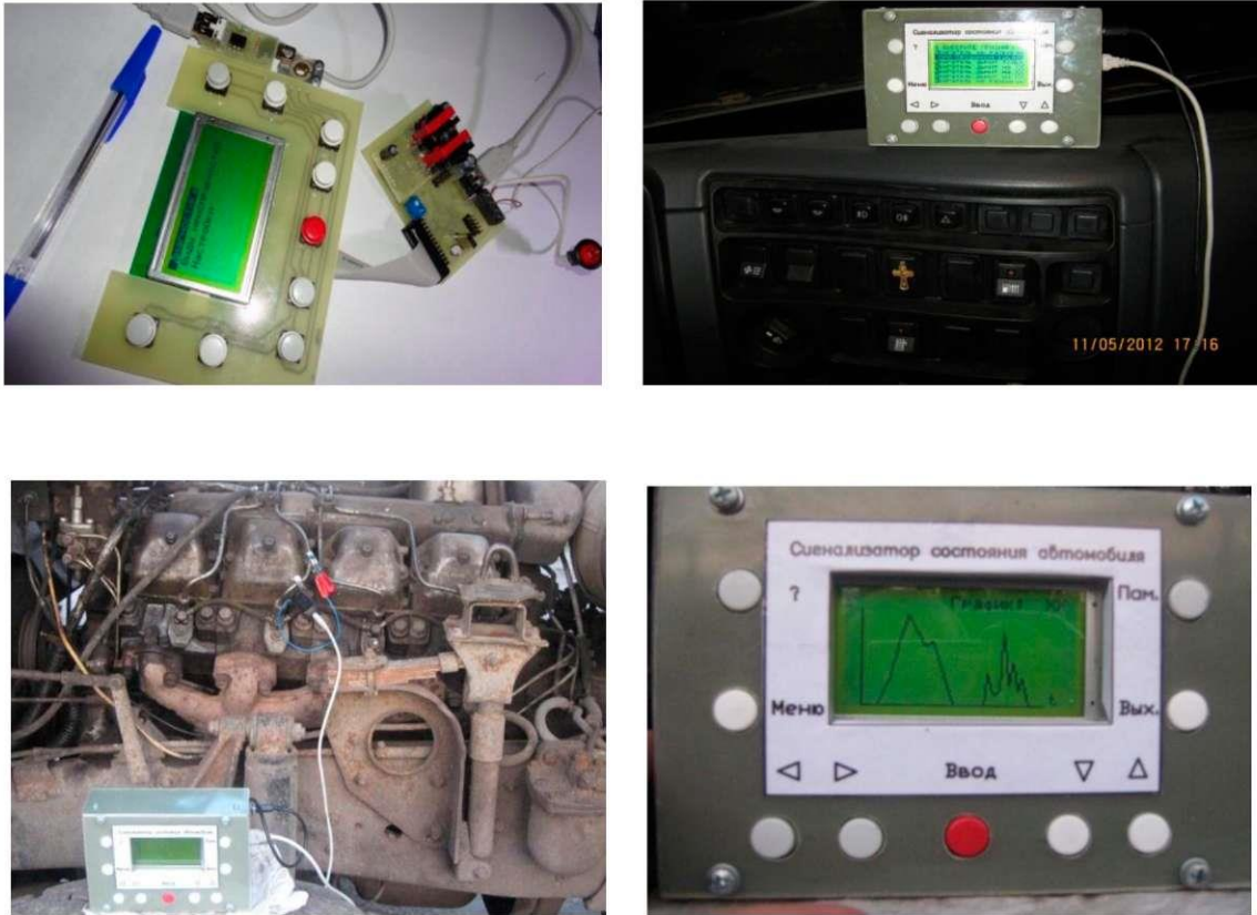
Рисунок 3.4 - Пропонована бортова система діагностики сміттєвоза МАЗ КО-427-73
