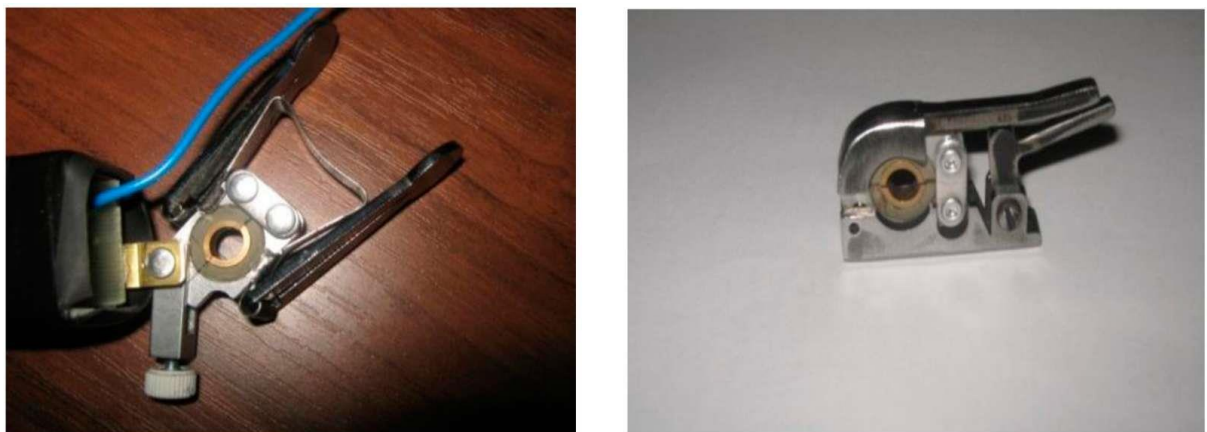
Рисунок 3.5 - Датчики тиску палива з пружинним і ексцентриковим кріпленням до трубопроводу
