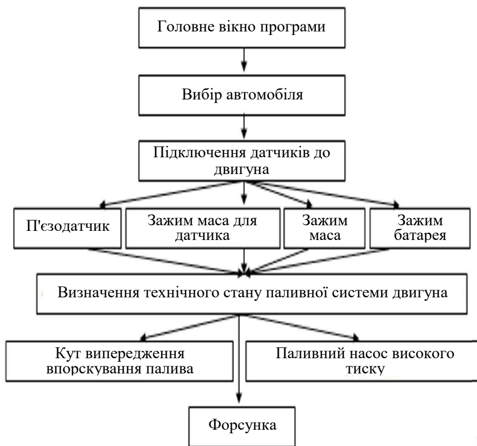
Рисунок 3.3 - Алгоритм програми контролю технічного стану двигуна
