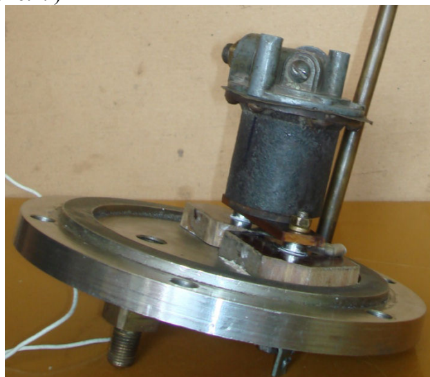
Рис.1. Загальний вигляд імпульсно-барботажного низьковольтного перемішуючого пристрою
