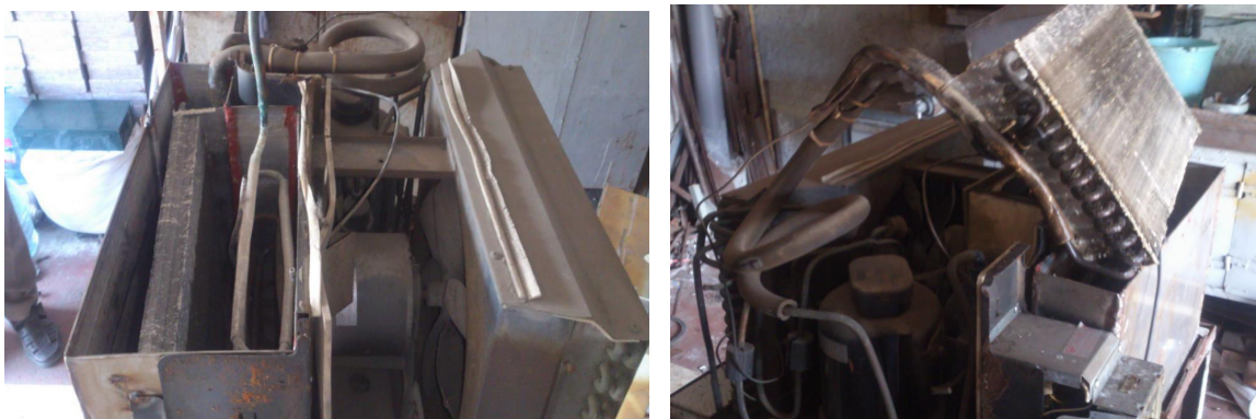
Рис. 2. Охолоджувач водного розчину на базі холодильної машини кондиціонера БК-1500
