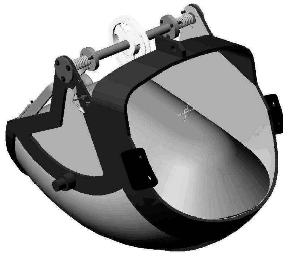
Рисунок 3 - Комп'ютерна модель ковша для добування сапропелю
