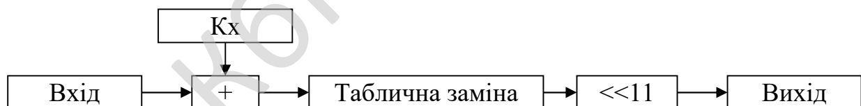
Рисунок 4.4 – Основне перетворення алгоритму ДСТ 28147:2009
