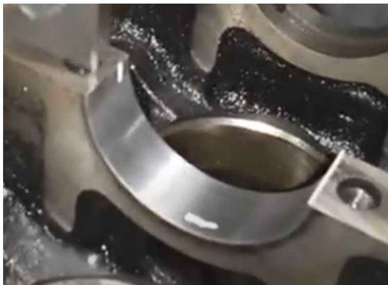
Рисунок 2.12 - Схема проміжного приварювання вкладишів.
