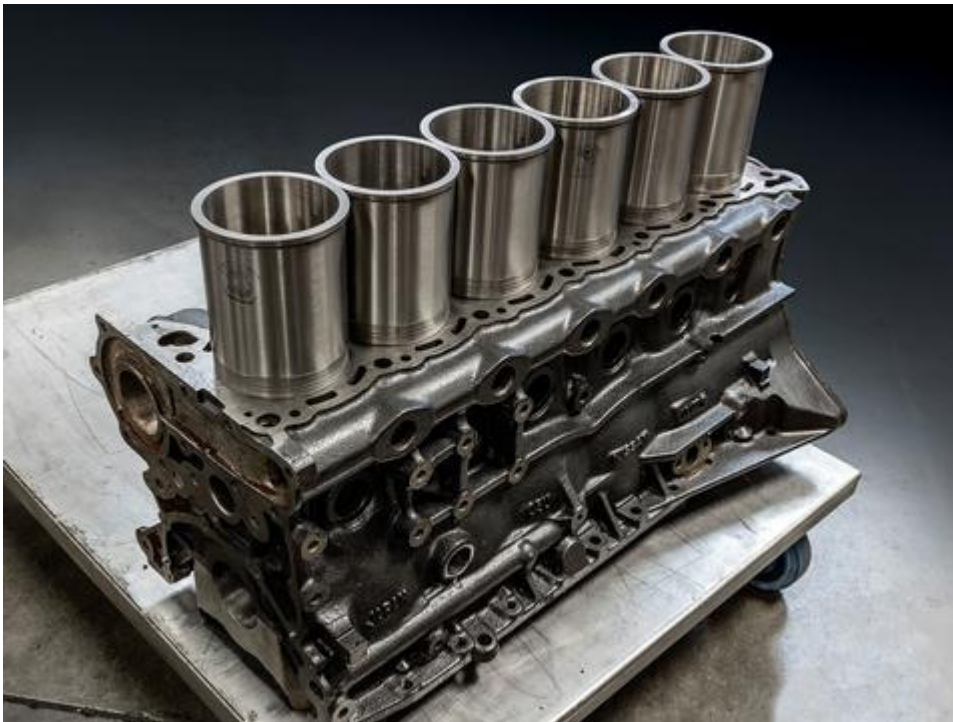
Рисунок 2.2 – Блок циліндрів із вставною гільзою.
