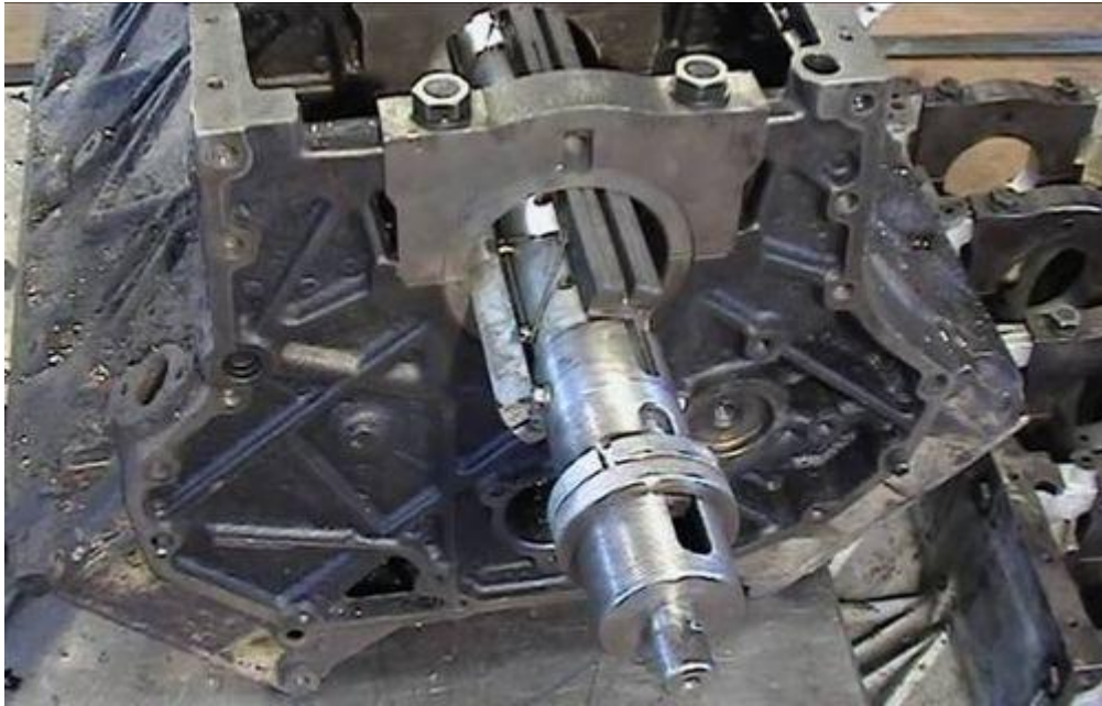
Рисунок 2.9 - Хонігування корінних опор.
