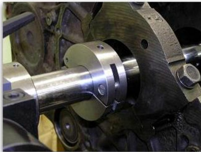
Рисунок 2.11 - Борштанга для розточування отворів корінних опор
