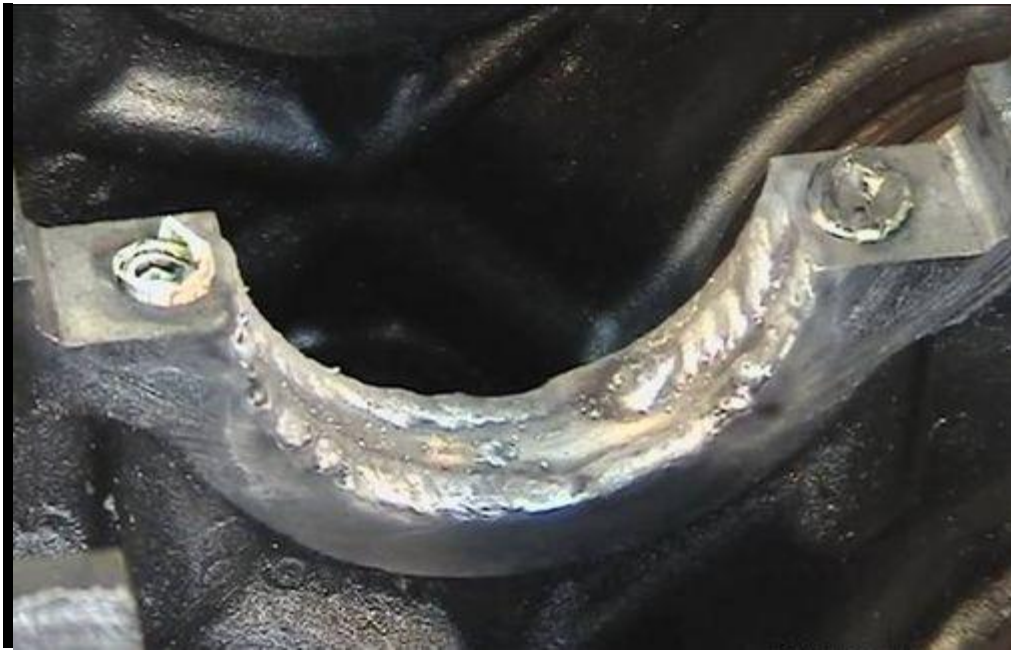
Рисунок 2.15 - Наплавлення корінних опор.
