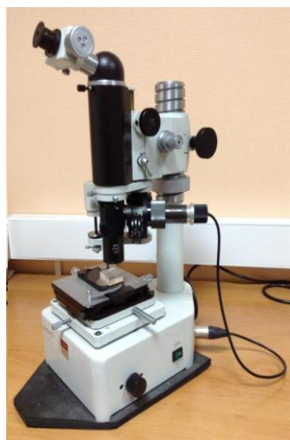
Рисунок 3.6 - Твердомір марки ПМТ – 3.
