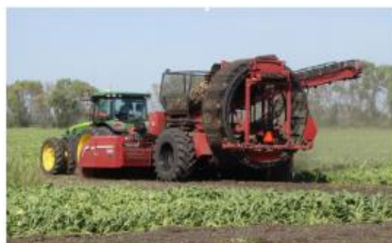
Комбайн бурякозбиральний AMITY з барабанним очисником
