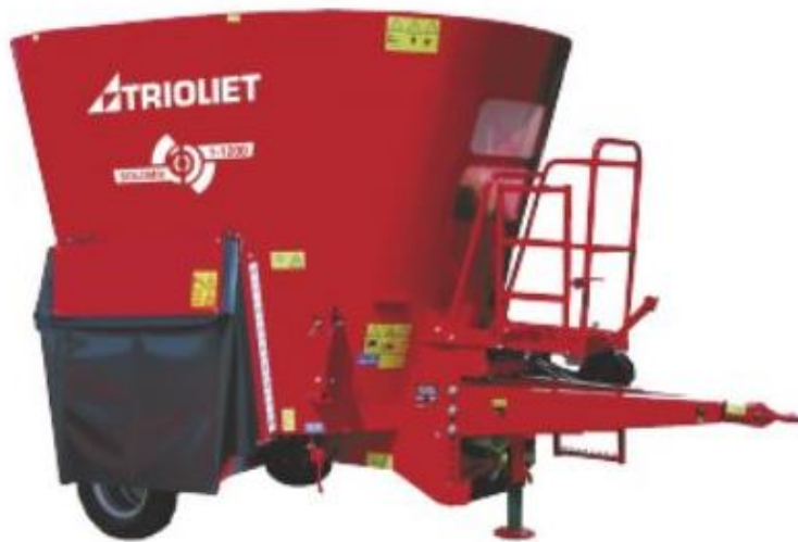
Рис. 3.3. Мобільний кормороздавач змішувач-кормороздавач Solomix 1 ZK
