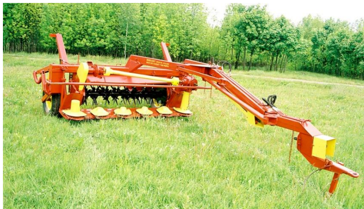
Рис. 4.2. Косарка - плющилка причіпна КПП-3,1
