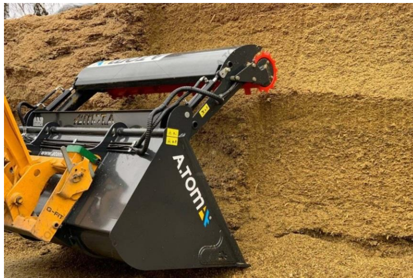
Рис. 3.2. Ківш із фрезою для силосу - А.ТОМ 2,0 м 3
