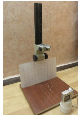
Рис. 3.16. Схема та загальний вигляд лабораторної установки для визначення коефіцієнта відновлення швидкості.
