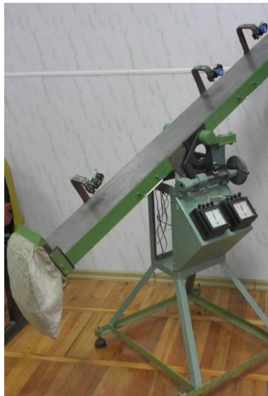
Рис. 3.13. Загальний вигляд та схема лабораторної установки для визначення коефіцієнта тертя методом скатної площини (за В.О. Желіговським).
