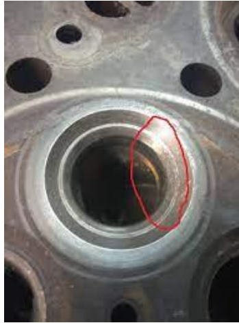
Рисунок 2.8 - Аварійне зношування сідел клапанів.
