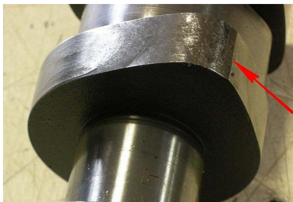
Рисунок 2.4 - Зношення кулачків розподільного валу.
