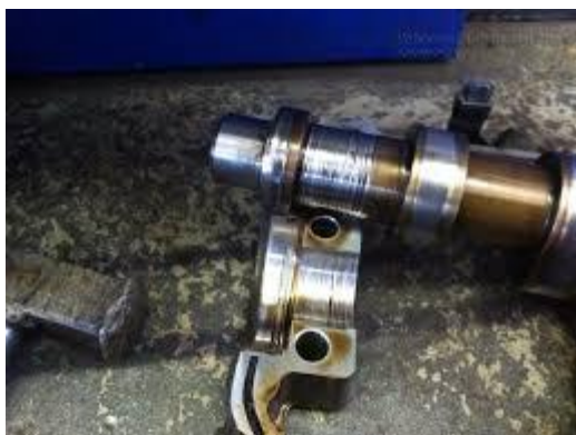
Рисунок 2.6 - Зношення посадочного місця під шків.
