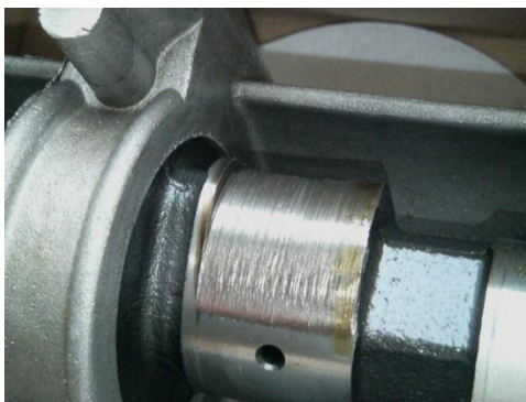
Рисунок 2.5 - Зношення опорних шийок розподільного валу.
