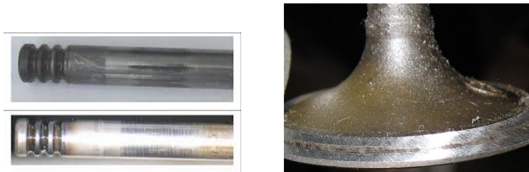
Рисунок 2.7 - Зношення стержня та фаски клапана.
