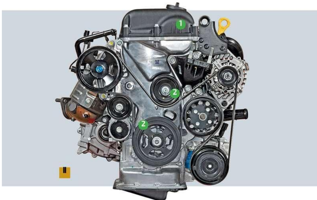
Рисунок 2.12 - Зони шумів, що прослуховуються на поверхні базових деталей двигуна.
