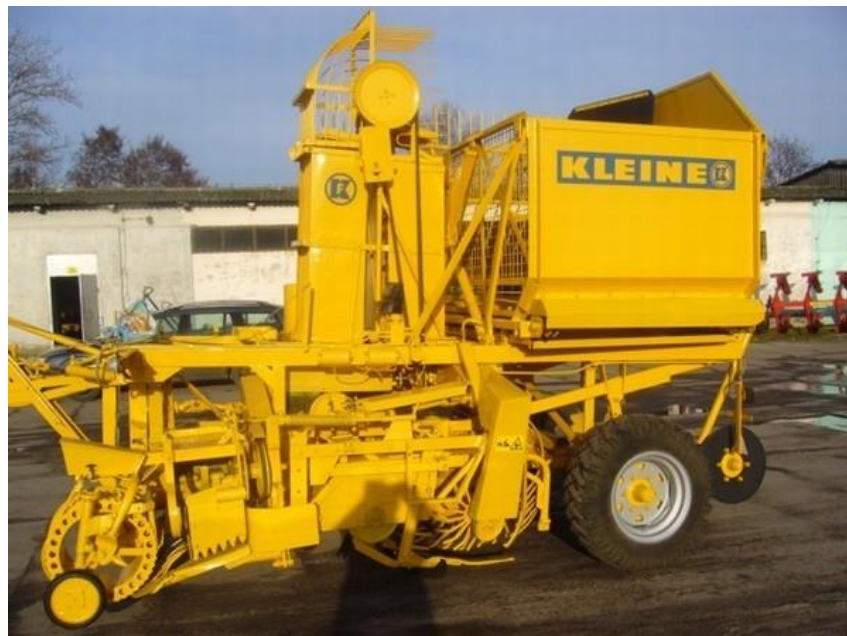
Рис. 3.2. Бурякозбиральний комбайн Kleine 5000 .
