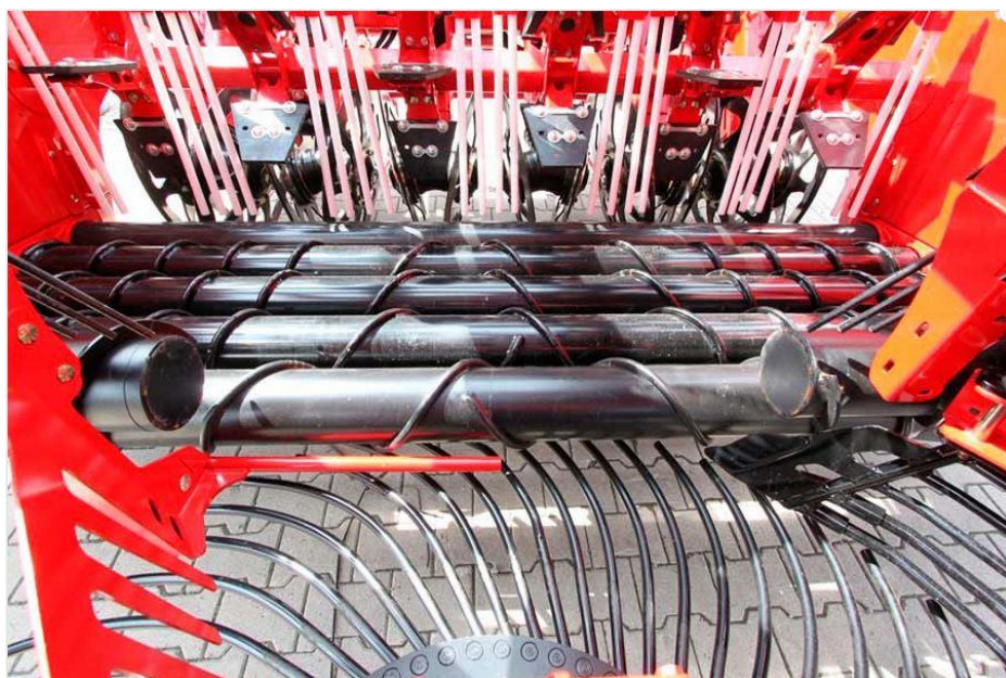
Рис. 3.5. Очисна система бурякозбирального комбайна Rootster 604 Grimme
