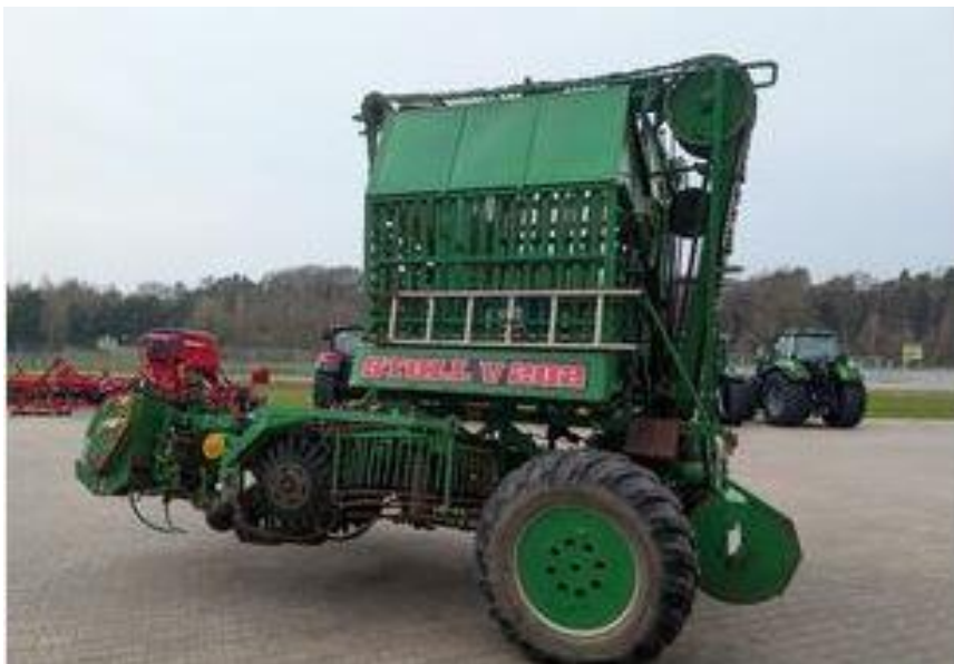
Рис. 3.6. Бурякозбиральний комбайн Stoll V 202
